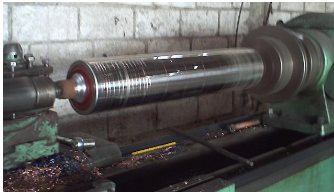
Fig. 6.50 Tambores desviadores y accionador de la banda (Fuente: Egdo. Paul Quispe)
