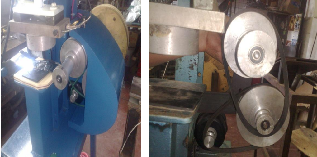
Fig. 6.53: colocación de poleas y tapa de protección
