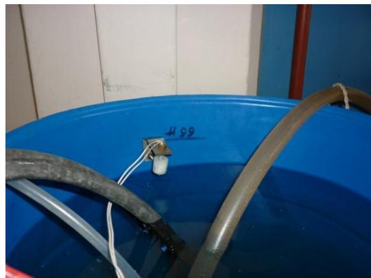
**Figura 6.4** Colocación de los sensores de nivel
