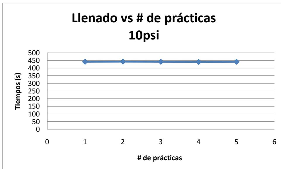
Gráfico N° 4.19 Tiempos de llenado del tanque con 10psi con el tablero de fluidos modificado
