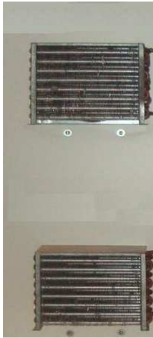
IMAGEN 6.21. Ubicación del evaporador y condensador (tablero frontal).
