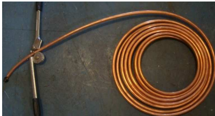
IMAGEN 6.7. Doblado de la tubería de cobre.
