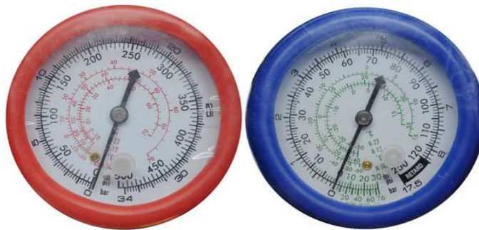
FIGURA 2.5. Manómetros de alta y de baja presión.
