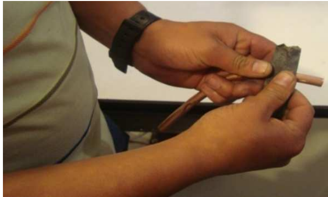
IMAGEN 6.6. Eliminación de rebabas en la tubería de cobre.
