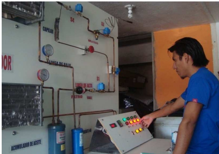
IMAGEN 6.40. Funcionamiento del equipo mediante el tubo capilar.
