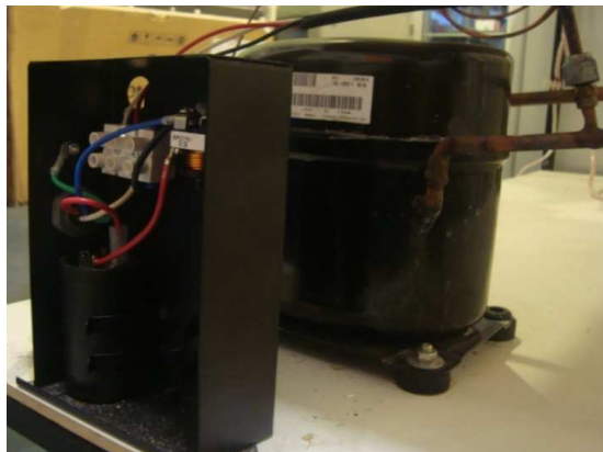
IMAGEN 6.22. Instalación del compresor y Kit capacitor de arranque.
