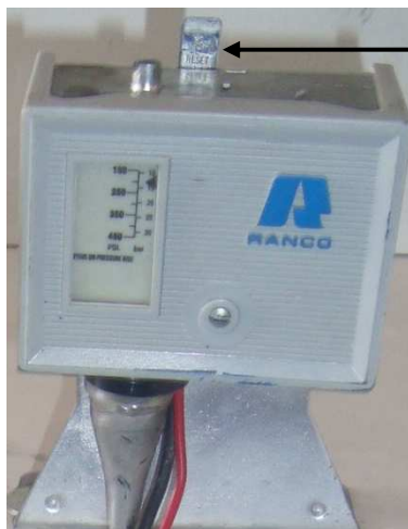
IMAGEN 6.48. Presostato de alta seteado.
