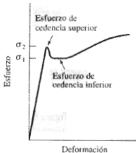
GRÁFICO 4 Esfuerzo de cedencia superior e inferior que describe el comportamiento mecánico de un acero al bajo carbono. FUENTE: ASKELAND, Donald R. (1998). Ciencia e Ingeniería de los Materiales. Thomson. México. (pág. 134)
