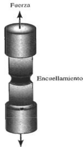
GRÁFICO 5 Deformación localizada durante el ensayo de tensión de un material dúctil produciendo una región de encuellamiento. FUENTE: ASKELAND, Donald R. (1998). Ciencia e Ingeniería de los Materiales. Thomson. México. (pág. 135)
