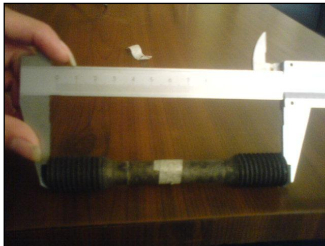
GRÁFICO 27 Probeta calibrada después de realizado el ensayo de tracción
