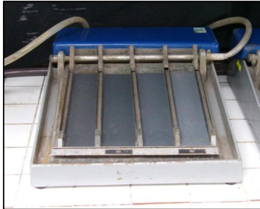
GRÁFICO 31 Banco de desbaste para cuatro tipos de papel abrasivo (240-320-400-600 granos por pulgada cuadrada)
