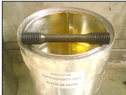
GRÁFICO 23 Probeta enfriada en Aceite de Oliva
