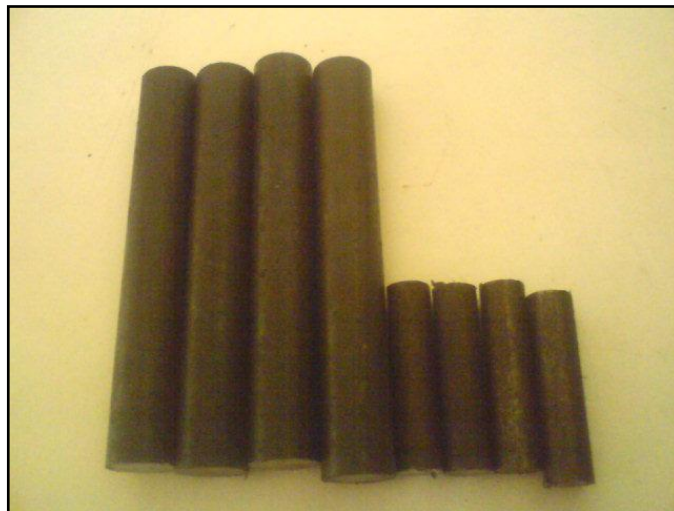
GRÁFICO 15 Ejes de acero AISI 1045 (Fábrica)
