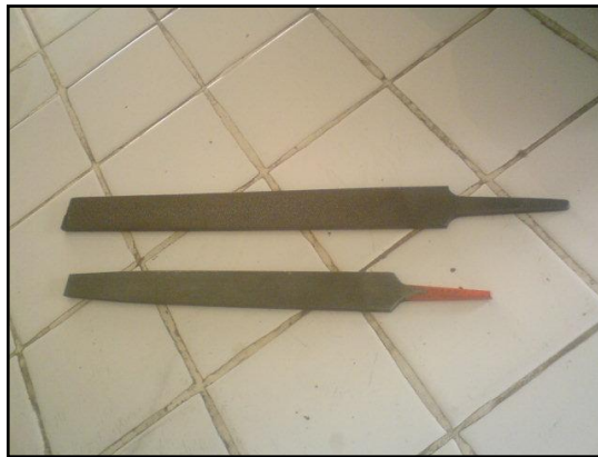
GRÁFICO 30 Lima media caña y lima fina utilizadas para el desbaste grueso
