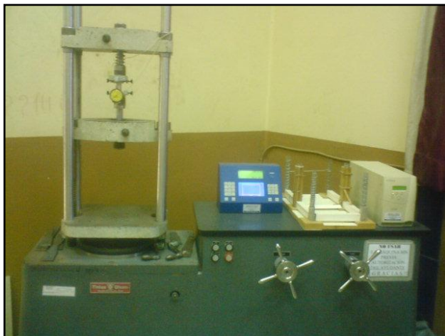
GRÁFICO 25 Máquina Universal Tinius Olsen capacidad 30 ton.
