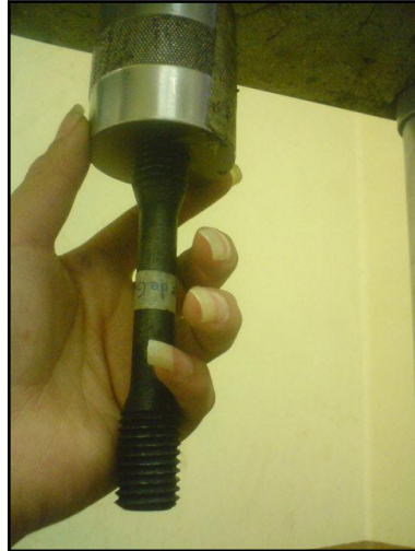
GRÁFICO 26 Ubicación de la probeta en el acople de la Máquina Universal Tinius Olsen capacidad 30 ton.
