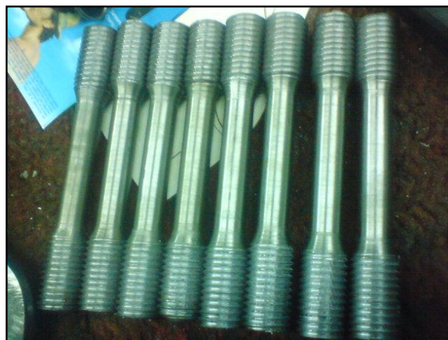
GRÁFICO 20 Probetas de Acero AISI 1045 para ser templadas
