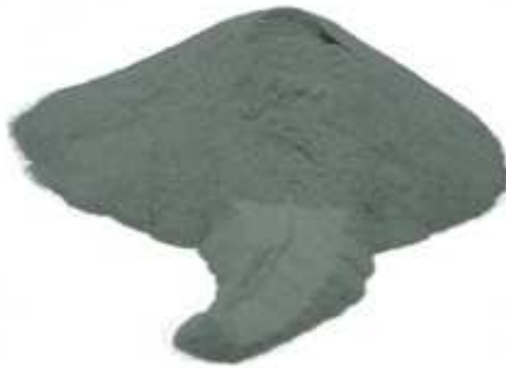
FIG N° 6.6.2. Arena para moldeo. ( Fuente: [11])
