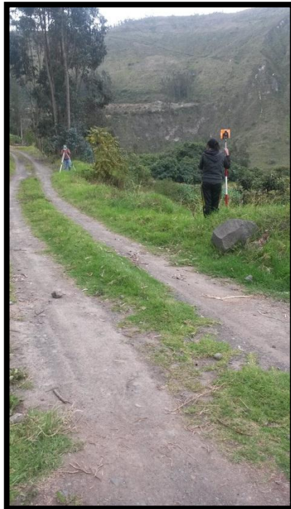
Toma de puntos con la estación Trimble M3.
