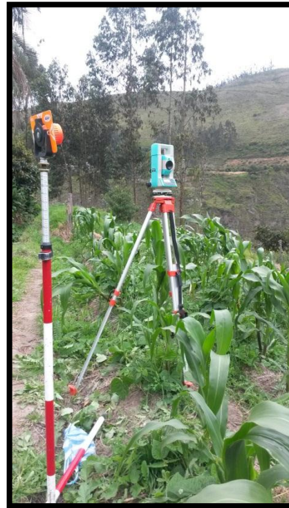
Toma de puntos con la estación Trimble M3.
