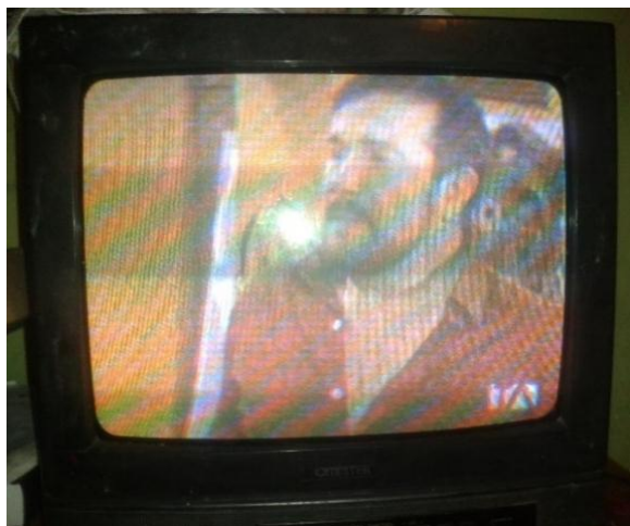
Fig. 4. 22 Interferencia por bandas horizontales en el TV Fuente: Elaborado por la investigadora
