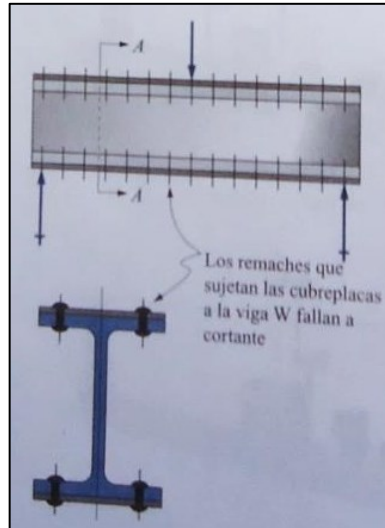
Figura 2.7. Falla de sujetador.
