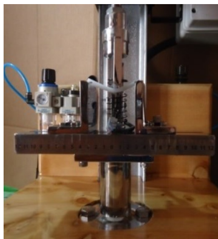
Figura 6.81. Ensayo de flexión pura probeta 4mm.
