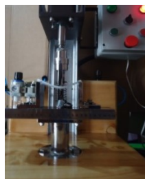
Figura 6.35. Ensayo de flexión pura probeta 6mm.
