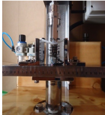
Figura 6.63. Probeta flexionada a 1.5 veces el espesor.
