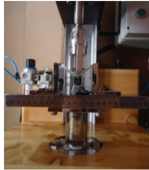
Figura 6.65. Flexión máxima en probeta.
