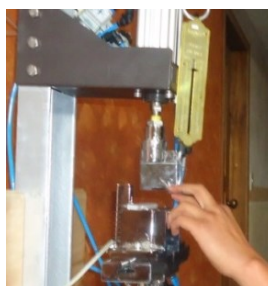
Figura 6.9. Medición de la fuerza en función del voltaje.
