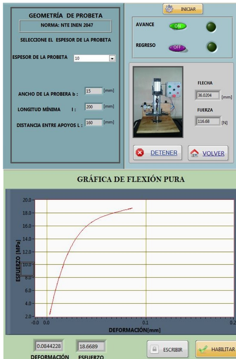
Figura 6.48. Diagrama esfuerzo – deformación espécimen N°1.
