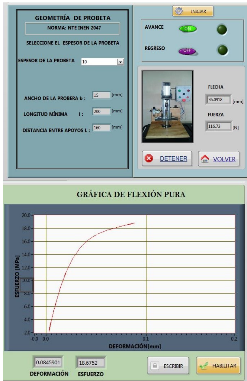
Figura 6.49. Diagrama esfuerzo – deformación espécimen N°2.
