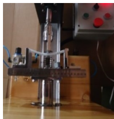
Figura 6.41. Ensayo de flexión pura probeta 8mm.
