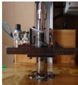
Figura 6.29. Ensayo de flexión pura probeta 4mm.
