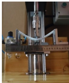
Figura 6.47. Ensayo de flexión pura probeta 10mm.
