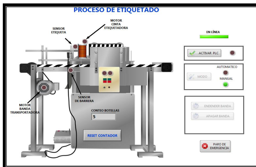
Figura 6.33: Panel frontal de la Etiquetadora.
