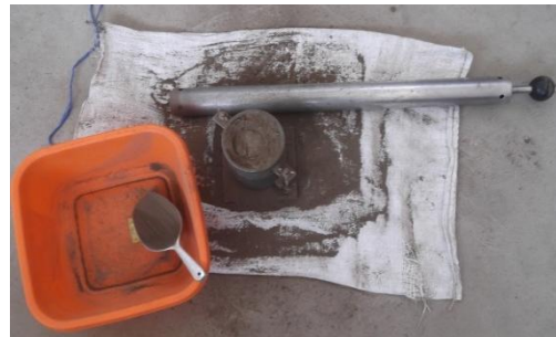
Colocación de capas para ser compactada cada una
