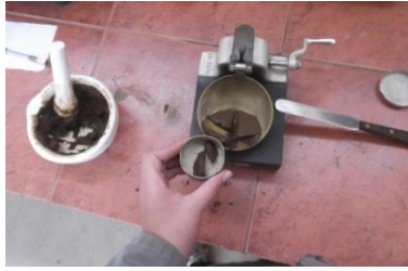
Toma de muestra para contenido de humedad
