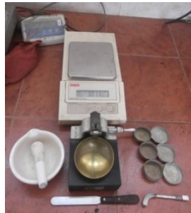
Colocación de suelo en el aparato Casagrande
