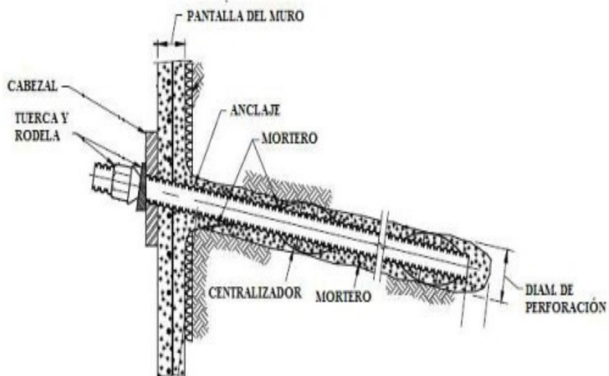
Gráfico 17: Partes estructurales de un anclaje
