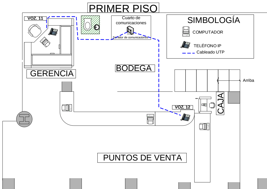
Figura 6.21 Ubicación de los teléfonos IP en el local principal.
