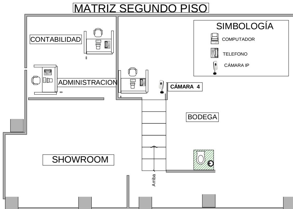
Figura 6.27 Ubicación de las cámaras IP en el local principal segundo piso.
