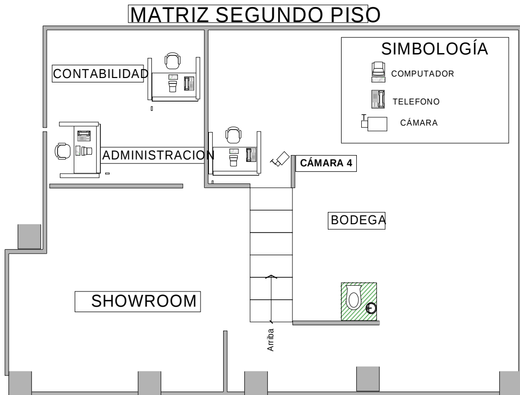
Figura 4.8. Ubicación de las cámaras en el segundo piso. En lo que respecta a la sucursal, actualmente no existe instalación o equipo alguno debido a que todo se maneja desde el almacén principal. Y no existe ningún enlace de datos entre los dos locales.
