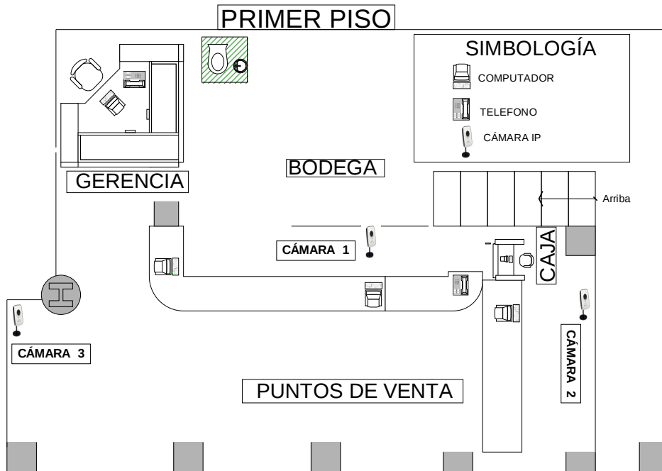
Figura 6.26 Ubicación de las cámaras IP en el local principal.
