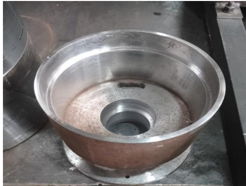
Figura 101. Vista superior del cubo.
