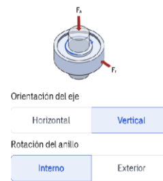
Figura 89. Condiciones de servicio del rodamiento 33108 [46].
