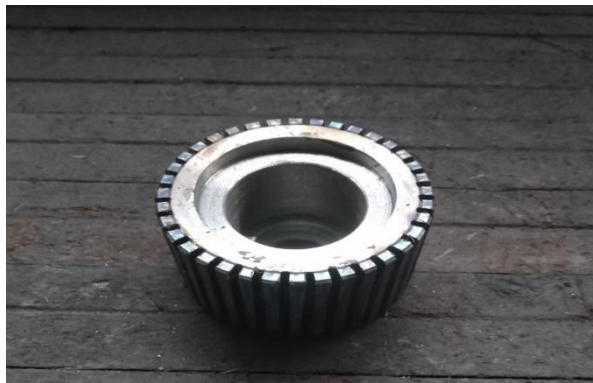
Figura 109. Mecanizado final del rodillo.
