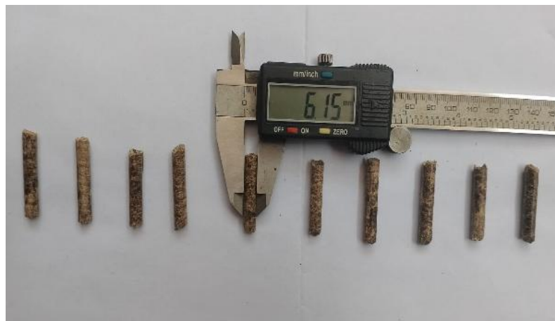
Figura 121. Resultado de la medida del diámetro de los pellets de aserrín.
