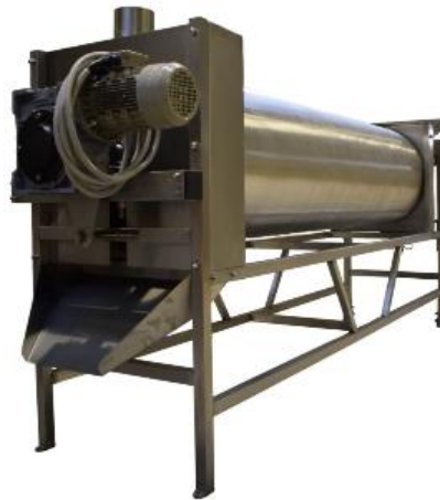
Figura 5. Mezclador de ciclo continuo con humificador [23].
