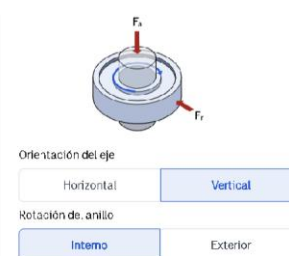
Figura 94. Condiciones de servicio del rodamiento 6008-2Z [46].
