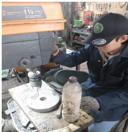
Figura 105. Mecanizado de orificios de la matriz.
