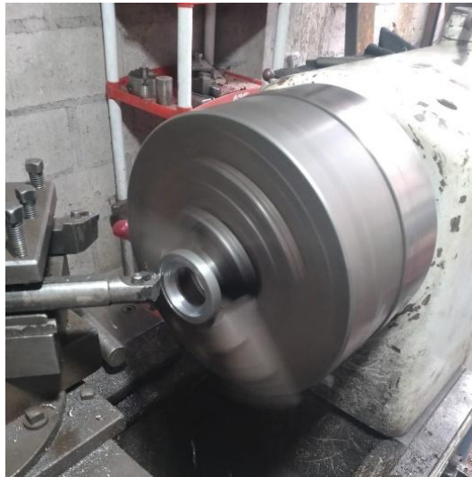
Figura 111. Mecanizado de la pieza en el torno.
