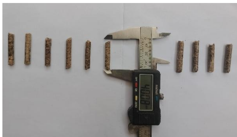
Figura 123. Resultado de la medida de longitud máxima de los pellets de aserrín.
