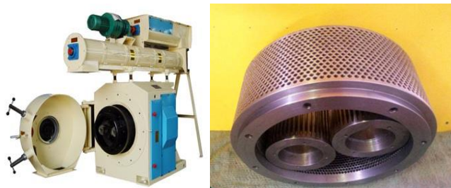
Figura 7. Peletizadora de matriz anular [25].
