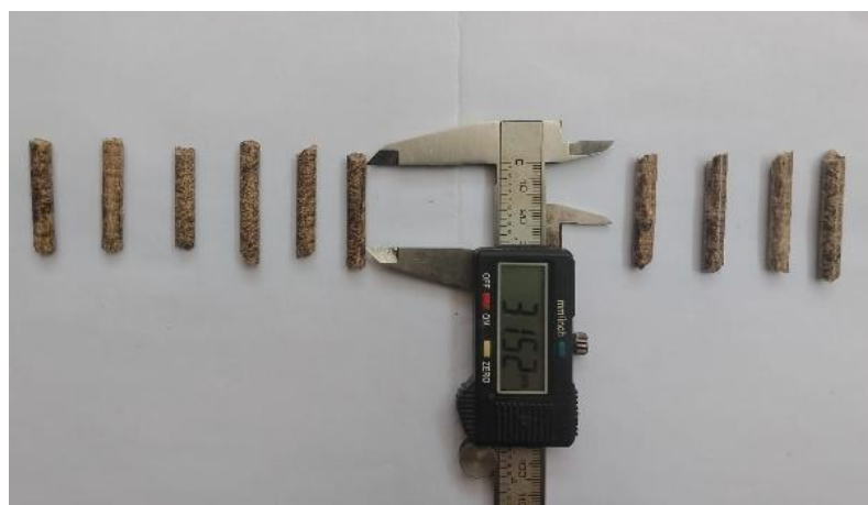
Figura 122. Resultado de la medida de longitud mínima de los pellets de aserrín.
