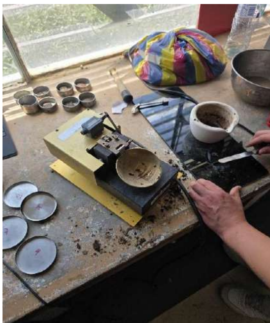
Fig 8. Elaboración de gusanillos para evaluar la humedad óptima del suelo.
