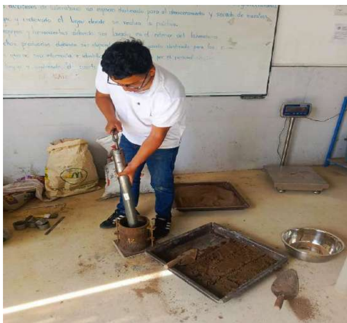
Fig 9. Ensayo Proctor Modificado – Método B (2025).
