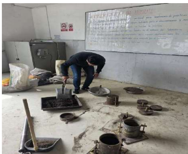
Fig 10. Compactación de suelo en Proctor para obtener su densidad máxima.
