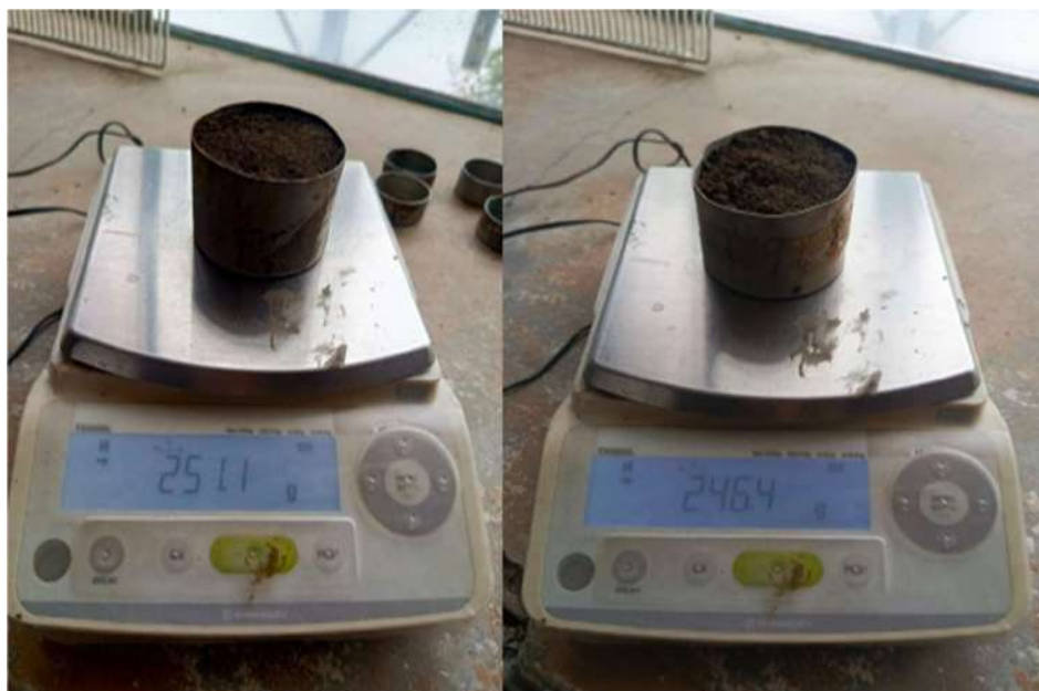
Fig 5. Muestras para ensayo de contenido de humedad.
