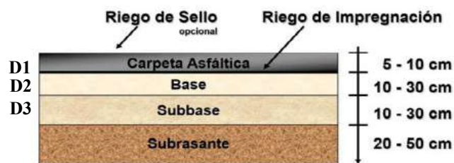
Fig 14. Estructura del pavimento flexible (2024).
