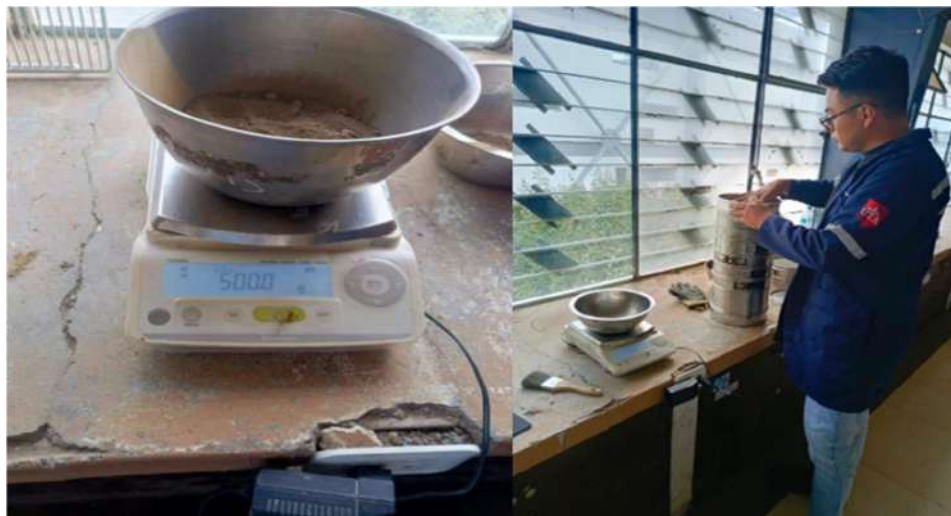
Fig 6. Ensayo de granulometría por tamizado.
