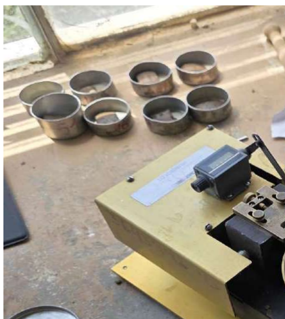
Fig 7. Muestras para determinación de contenido de humedad.
