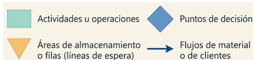
Figura 2. Elementos diagrama de flujo de procesos
