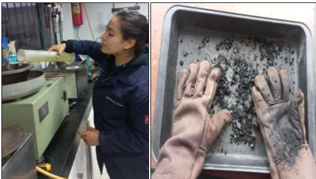
Fig. 10 Ensayo de Centrifugado del RAP
