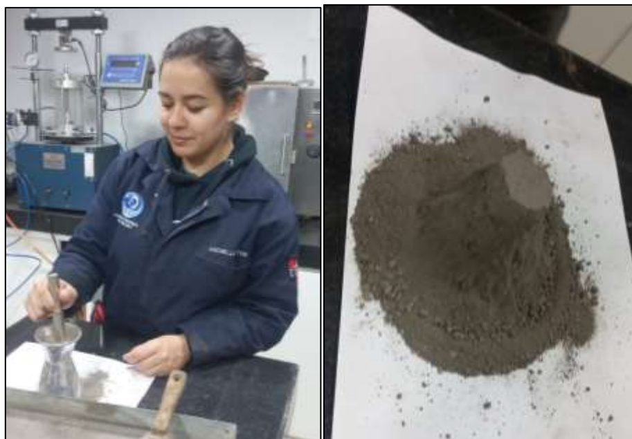
Fig. 8. Ensayo de Gravedad Específica - Agregado Grueso y Fino
