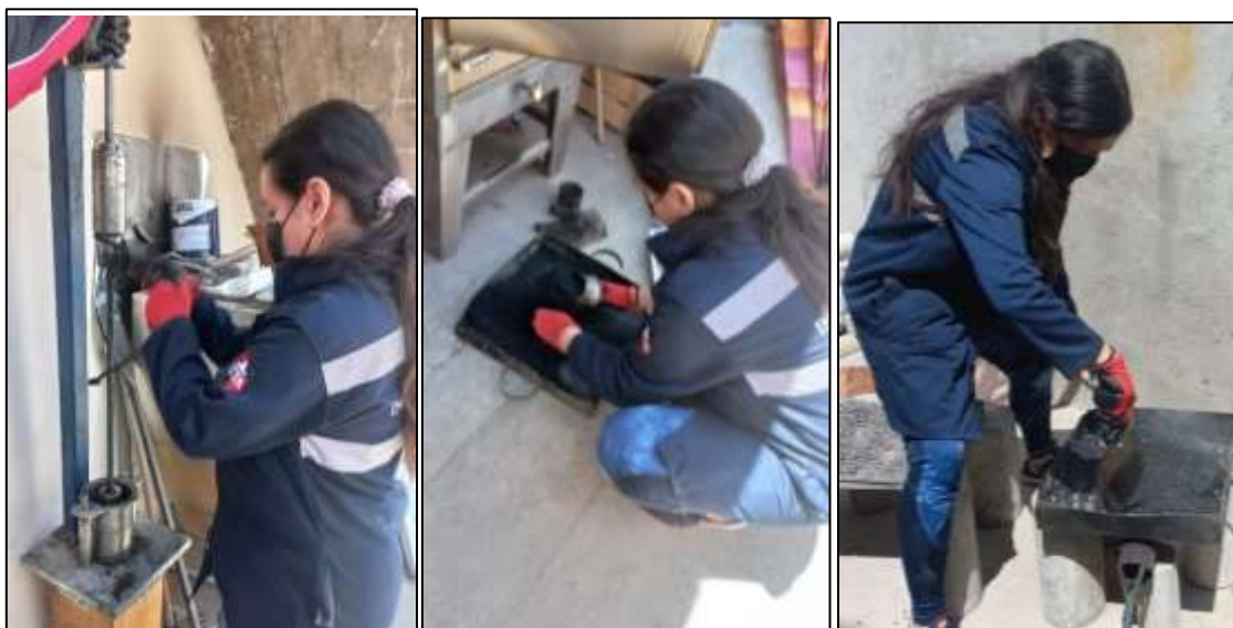
Fig. 11. Elaboración de briquetas – Mezcla Asfáltica Tradicional
