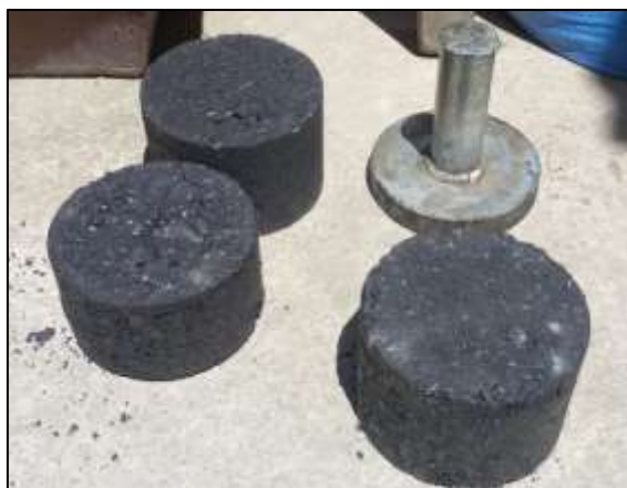
Fig. 12. Elaboración de briquetas – Mezcla Asfáltica Modificada
