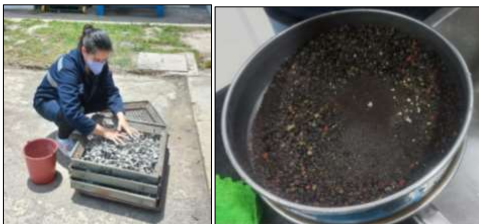
Fig. 6. Ensayo de Granulometría - Agregado fino y grueso
