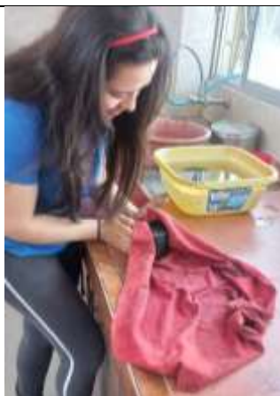
Secado de briquetas posteriormente saturadas en agua
