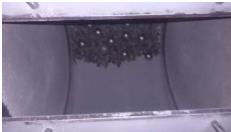
Fig. 7. Ensayo de Abrasión – Máquina de los Ángeles
