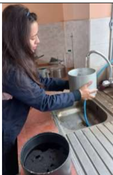
Llenado de agua con material para ensayo RICE
