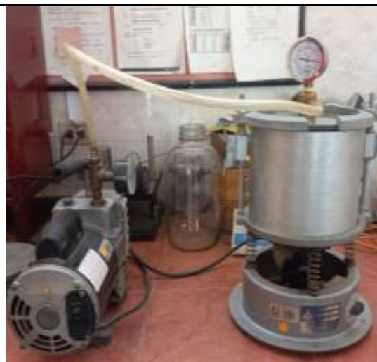
Realización del ensayo RICE
