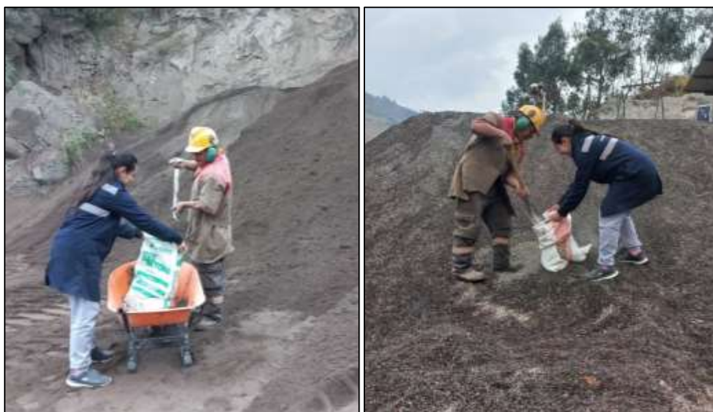
Fig. 15 Extracción de los materiales pétreos 3/4", 3/8" y Fino
