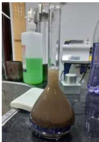
Fig. 9. Ensayo Gravedad Específica - Agregado fino
