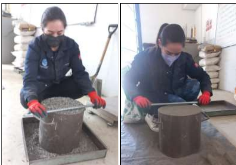
Fig. 5. Ensayo Pesos Unitarios - Agregado Grueso y Fino
