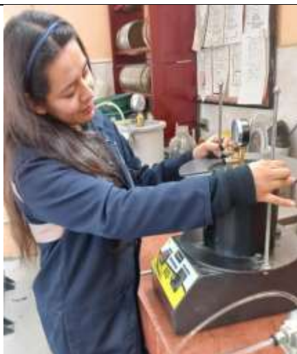
Colocación de Ollas en Máquina de Vacíos
