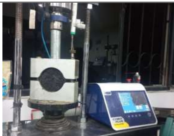
Briquetas ensayadas en Máquina Marshall
