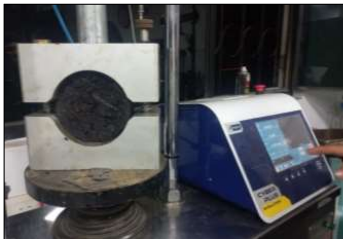
Fig. 13. Ensayo de briquetas en Máquina Marshall
