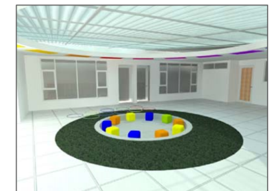
Fig. 3: Tumbado de Gypsum, anclado a la estructura metálica, pintado blanco satinado con colores como se muestra en la figura y en la fotografía, incluirá una iluminación artificial de flafones redondos de bajo consumo.
