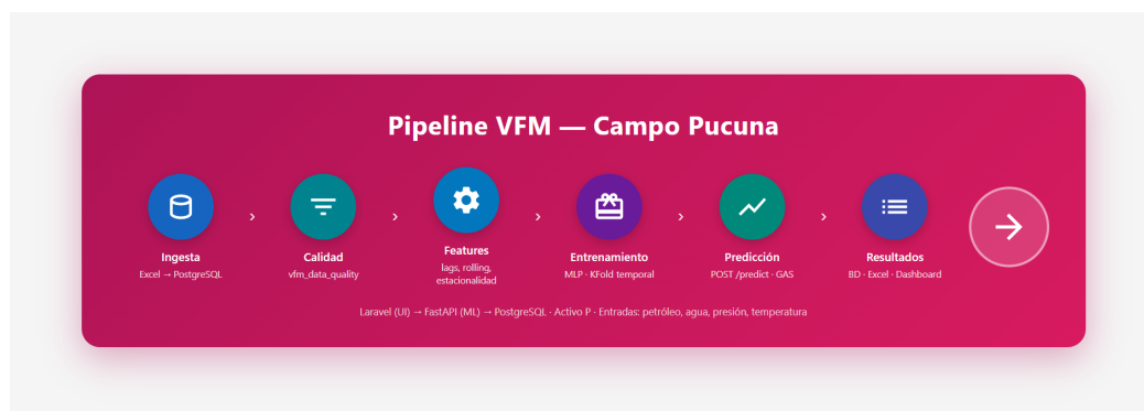
Figura 22: Pipeline del sistema VFM
