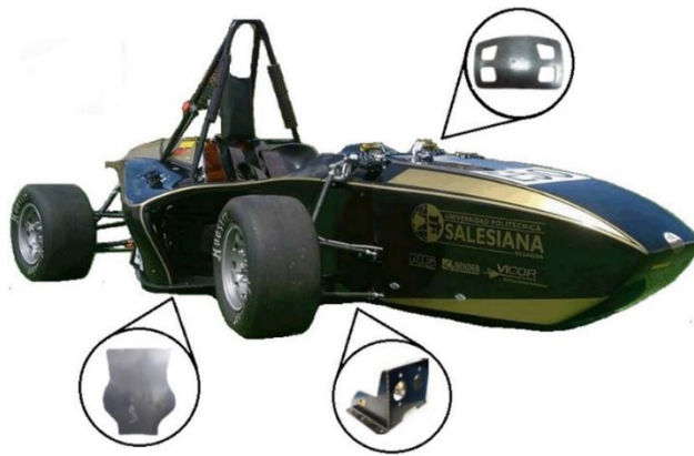
Figura 15 Componentes del vehículo FSAE UPS fabricados con preimpregnado de fibra de carbono.
