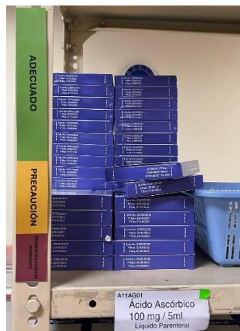
Figura 44. Sistema Poka-Yoke en estanterías
