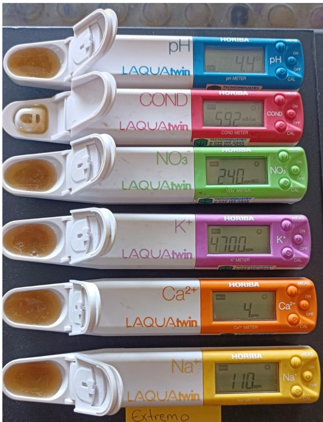
Figura 21. Sistema de electrodos sensibles a iones específicos, denominado medidor LAQUAtwin
