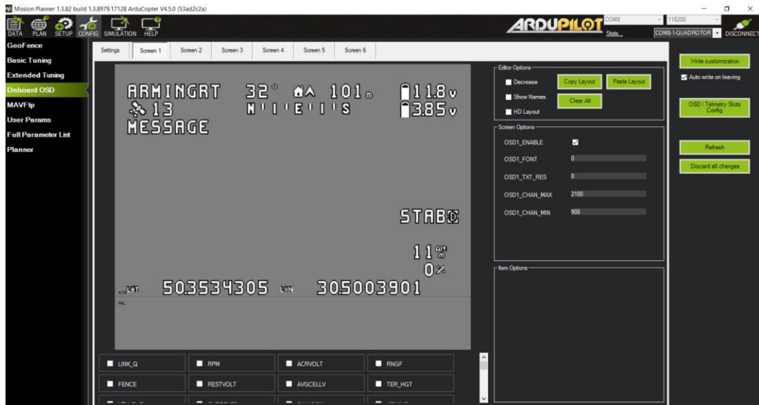
Figura 57. Configuración del OSD en el software Mission Planner.
