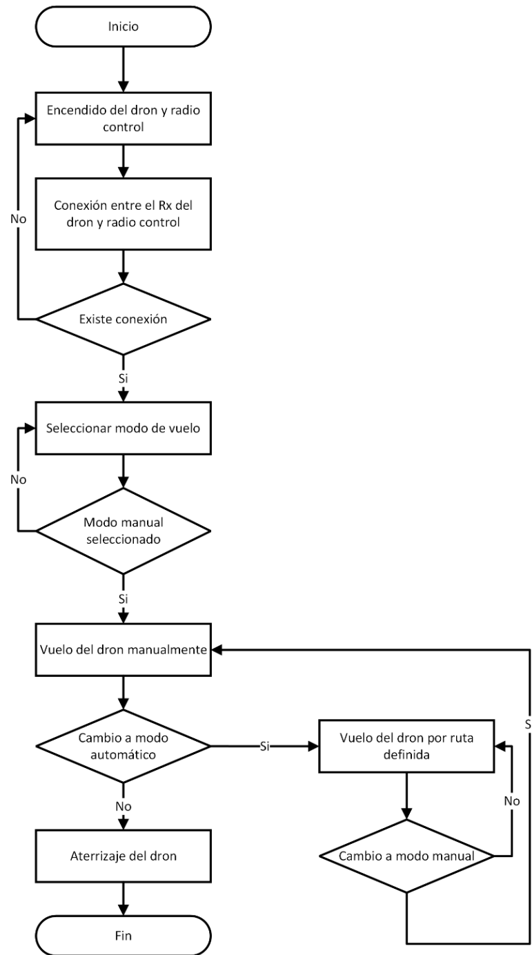
Figura 36. Diagrama de flujo del proceso del funcionamiento del UAV.
