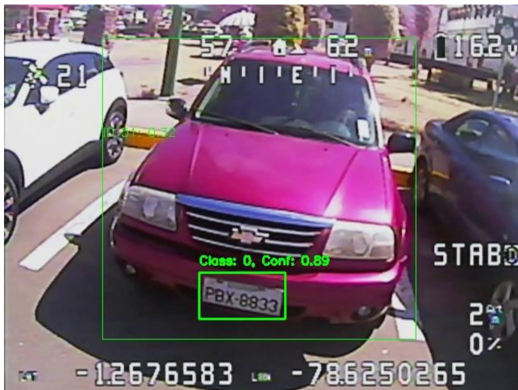
Figura 96. Placa detectada en vehículo.
