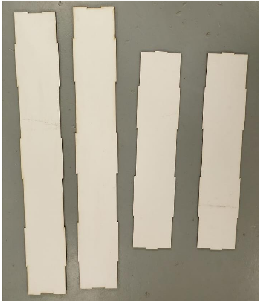
Figura 43. Piezas laterales de la estación de carga
