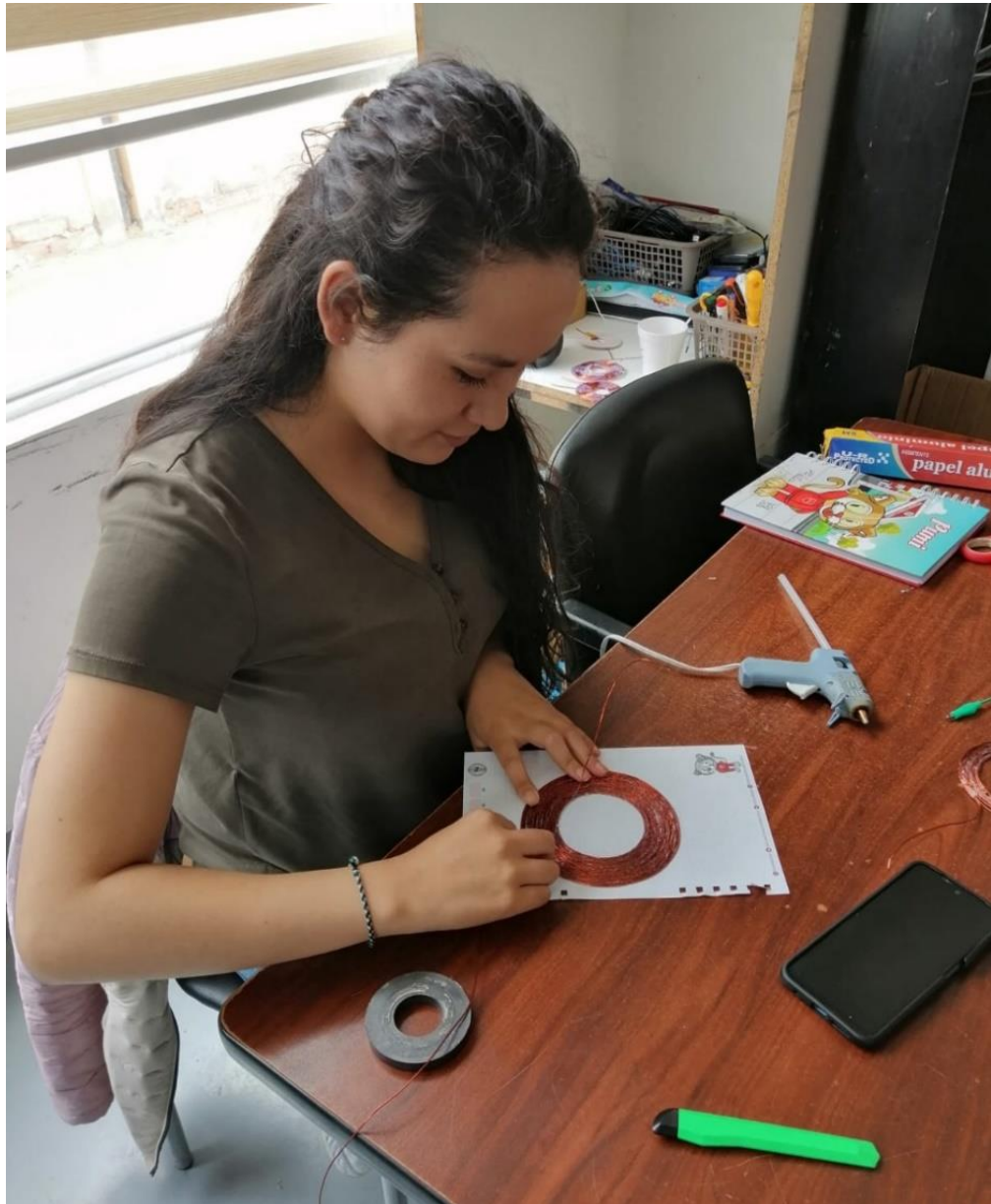
Figura L1. Construcción de las bobinas con el cable de cobre esmaltado
