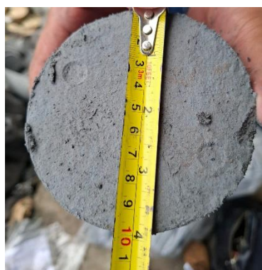
Figura 12. Diámetro de cilindro compactado.
