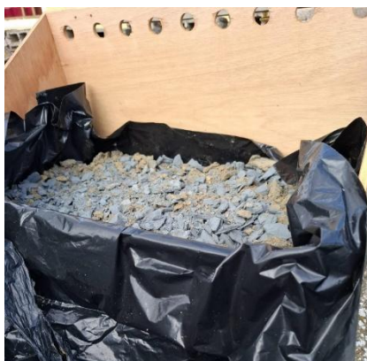
Figura 29. Disposición de polvo residual de cuero en secador manual
