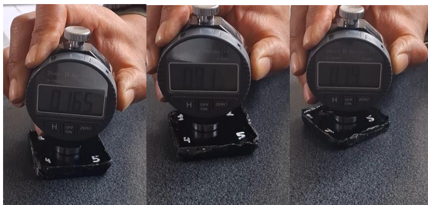
Figura 53. Probetas sometidas a ensayo de dureza
