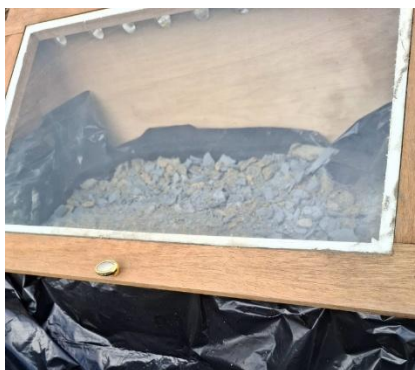
Figura 30. Proceso de eliminación de humedad en el polvo residual de cuero.
