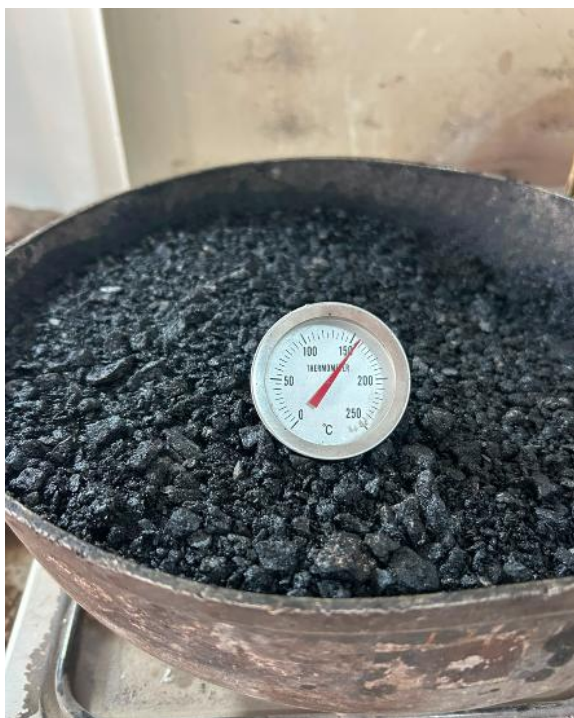
Fotografía 1: Muestra asfáltica en caliente.
