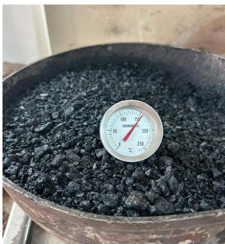
Fig. 27. Temperatura de la mezcla asfáltica
