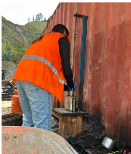
Fig. 28. Proceso de compactación de la mezcla asfáltica
