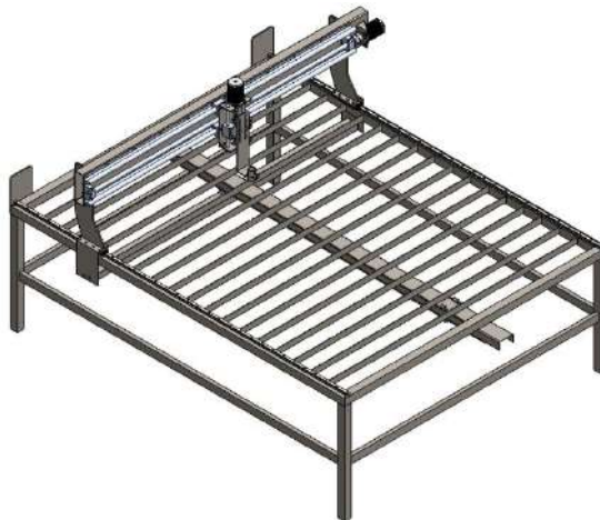
Figura. 28. Prototipo de máquina de corte de plasma CNC.
