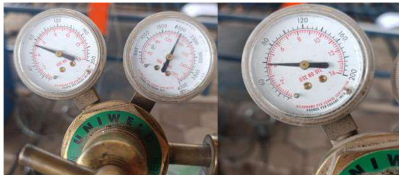
Figura. 30. Rango de presión de trabajo (58 – 72,5) Psi.
