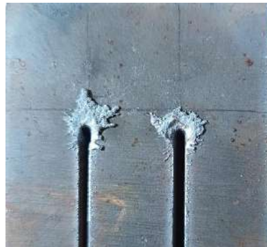
Figura. 34. Defectología de inicio de corte.
