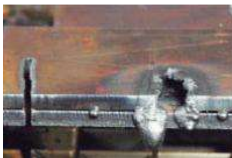
Figura. 31. Defectología en cortes realizados con arco de plasma.
