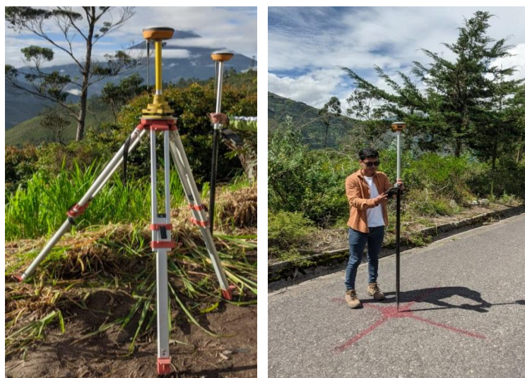
Fig. 1 Levantamiento Topográfico con RTK
