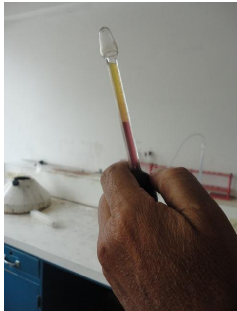
Fotografía D4. Lectura de Materia Grasa en Leche Cruda
