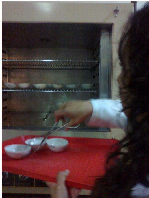
Fotografía D24. Determinación de humedad en Queso Mozzarella
