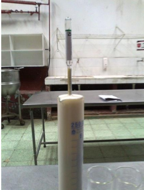
Fotografía D1. Determinación de Densidad Relativa en Leche Cruda
