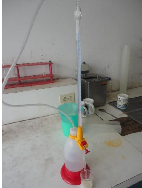
Fotografía D2. Determinación de Acidez Titulable en Leche Cruda
