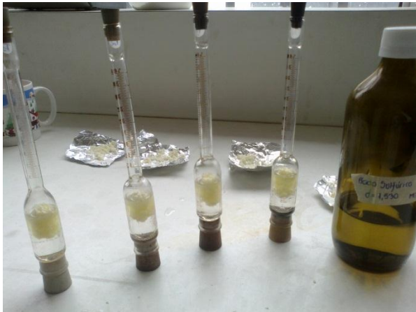
Fotografía D22. Determinación de Materia Grasa en Queso Mozzarella
