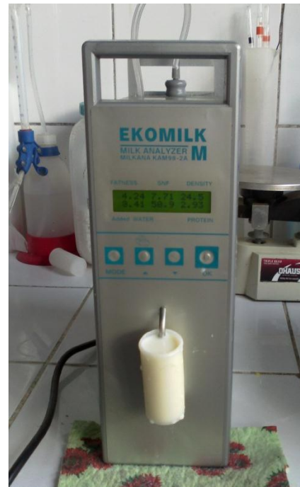
Fotografía D6. Determinación de proteína y sólidos no grasos en Leche Cruda
