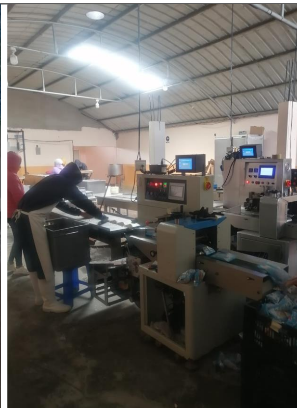
El piso no es liso. Columnas que pueden llegar acumular polvo. Poca iluminación. Falta de sistemas de circulación de aire en el techo.
