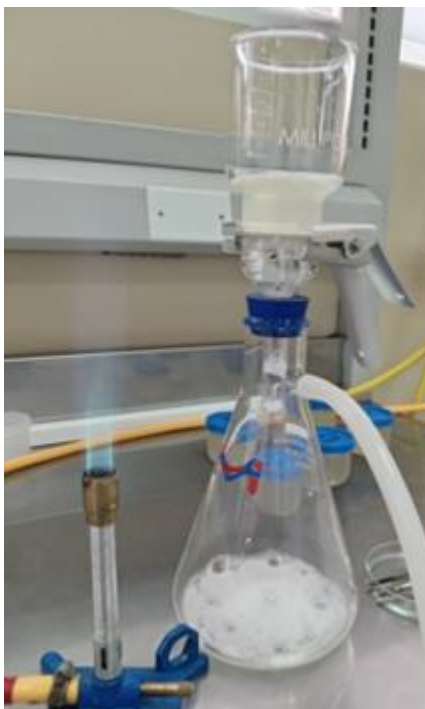
Figura 12. La espuma formada representa a la capacidad para reducir la tensión superficial por parte de los aislados bacterianos.
