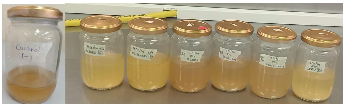
Figura 15. Biodegradación del segundo ensayo con sustrato (aceite comestible + melaza+ azúcar como fuente de carbono) después de dos semanas de incubación.
