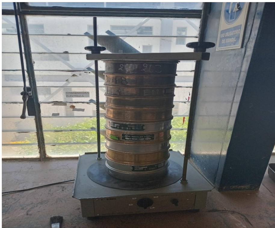
Fig. 7. Muestra en la tamizadora eléctrica
