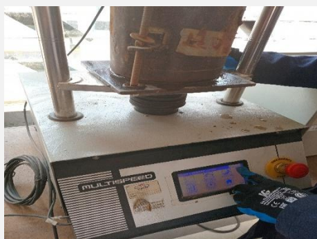
5. Ensayo en la máquina de CBR
