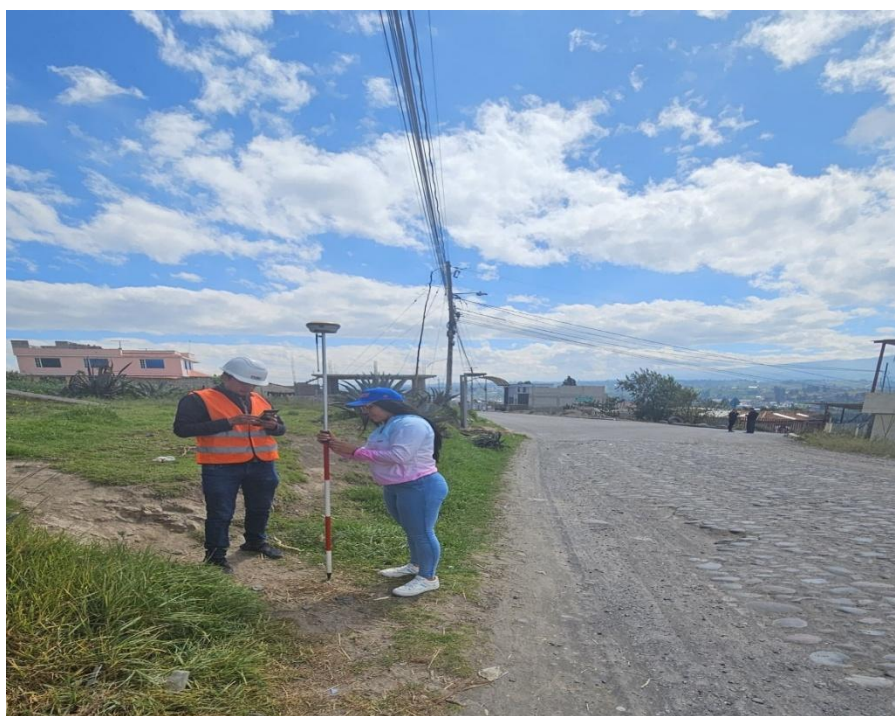
Fig. 2 Levantamiento Topográfico con RTK
