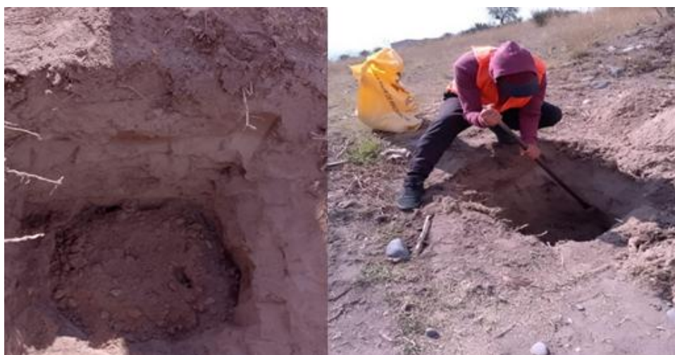
Fig. 5. Excavación y extracción de muestras de suelo
