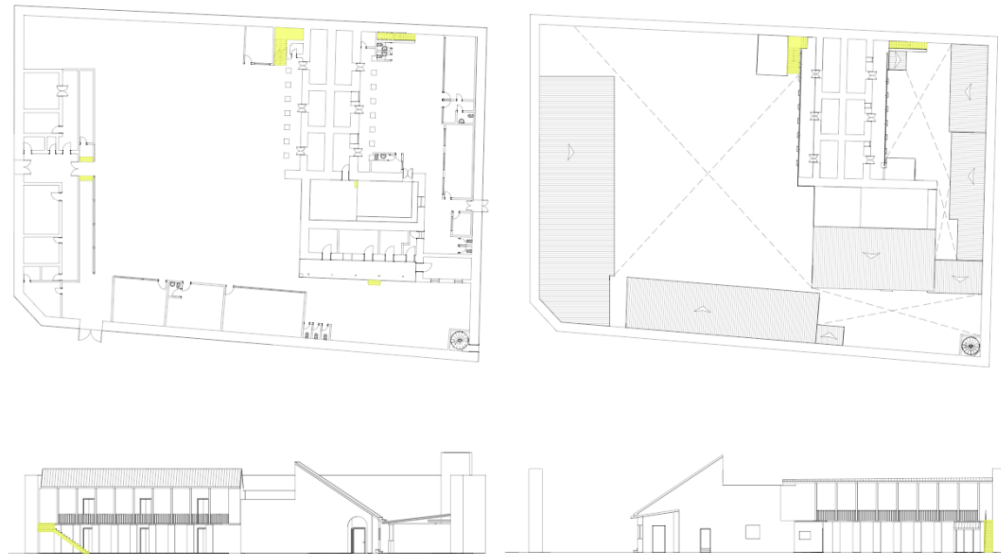
Figura 23. Circulaciones Verticales de la antigua cárcel de Latacunga. Elaboración propia (2026).
