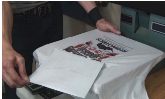
Imagen N° 110: Estampado de una camiseta por transferencia de calor
