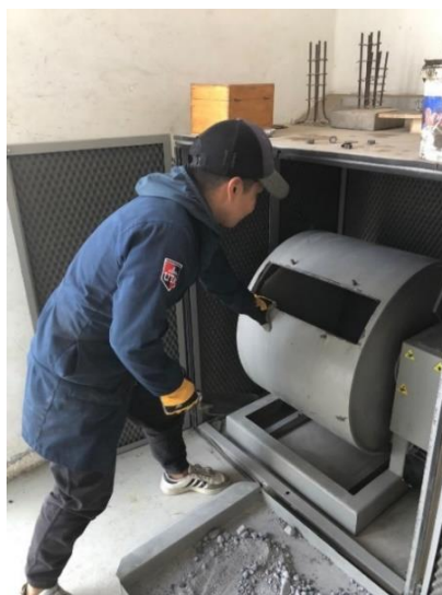
Figura 9.- Retiro de material después del ensayo
