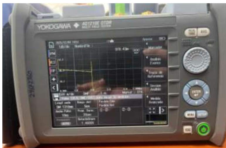
Figura 56. Medición experimental de un tramo de fibra óptica de aproximadamente 978.43 m.
