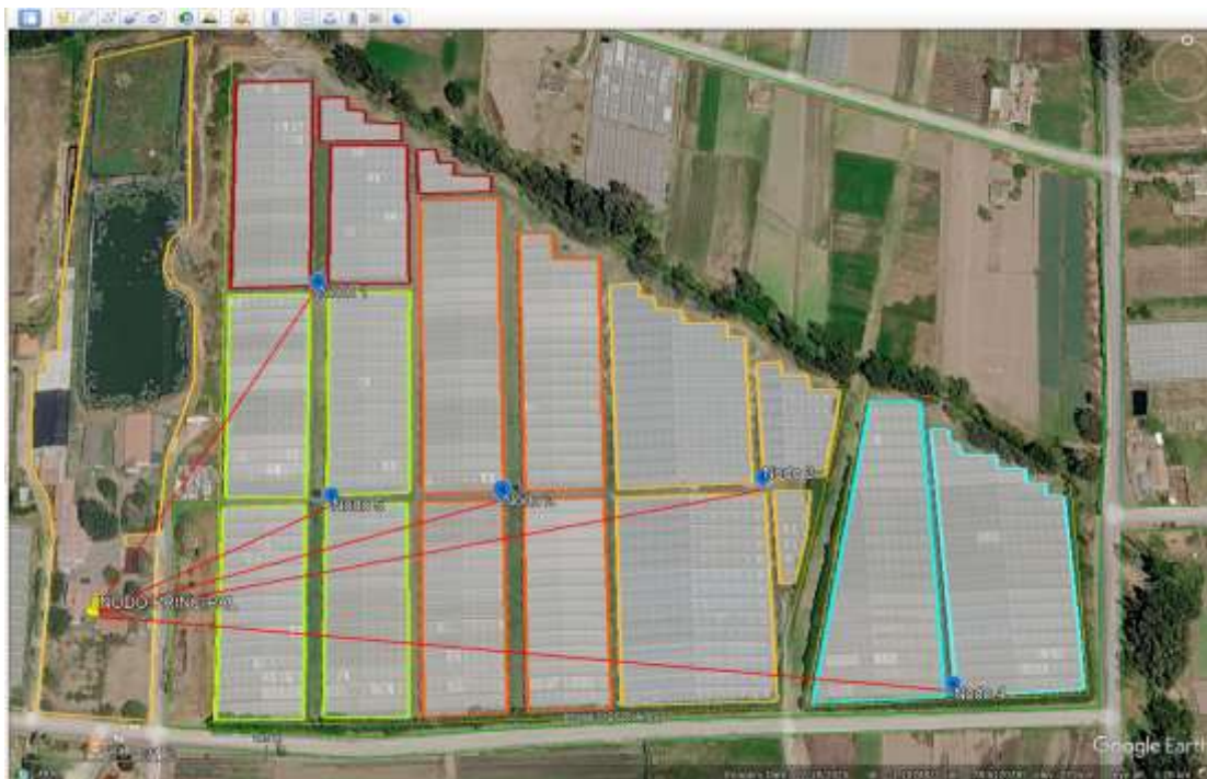
Figura 16. Distribución física de los nodos
