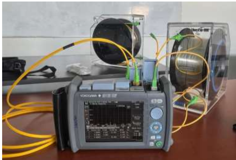
Figura 54. Montaje experimental para la validación de fibra óptica mediante OTDR.
