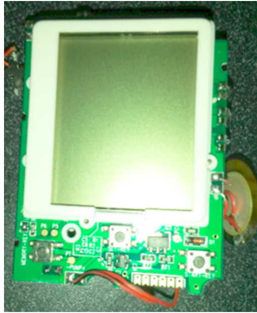
Figura 4.15: Placa central de dispositivo de presión arterial.
