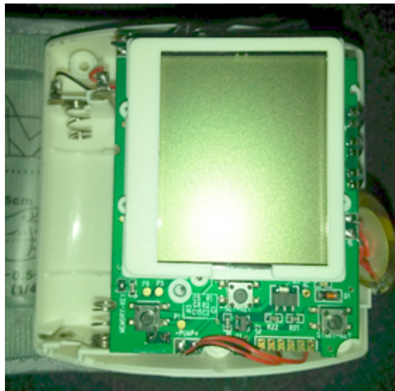
Figura 4.14: Vista interna de dispositivo de presión arterial WHO.
