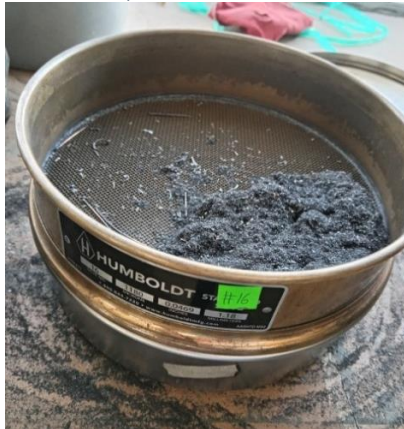
Figura 17 Tamiz Humboldt N.º 16, con una abertura de malla de 1,18 mm (1180 \mu m).
