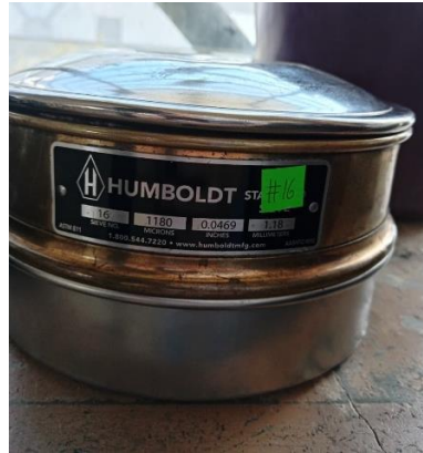
Figura 17 Tamiz Humboldt N.º 16, con una abertura de malla de 1,18 mm (1180 \mu m).
