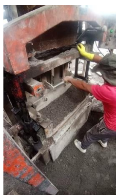
Figura 26 Colocación de la mezcla en los moldes.
