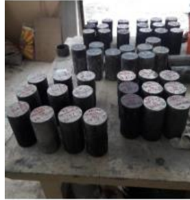
Figura 4 Cilindros de hormigón con virutas metálicas.
