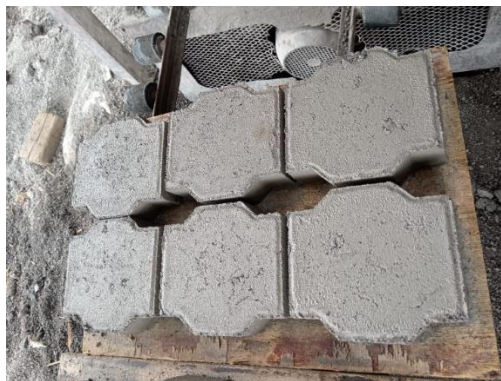
Figura 28 Adoquines hexagonales con el 10% de limallas metálicas.
