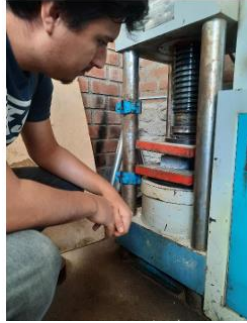
Figura 5 Ensayo de resistencia a compresión del adoquín de concreto.
