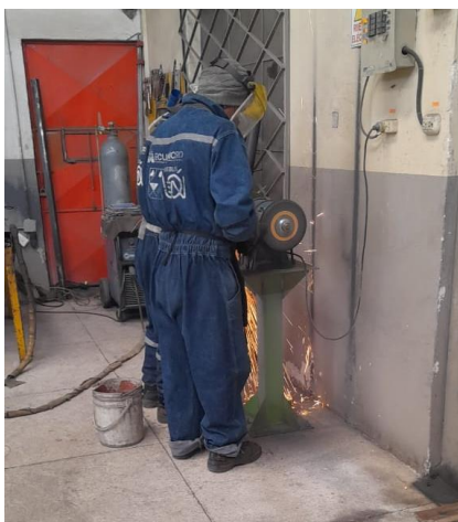
Figura 15 Pulido de tubos metálicos donde se obtienen las limallas.
