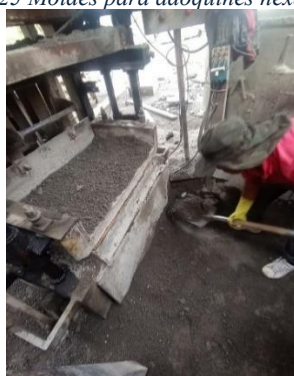
Figura 25 Moldes para adoquines hexagonales
