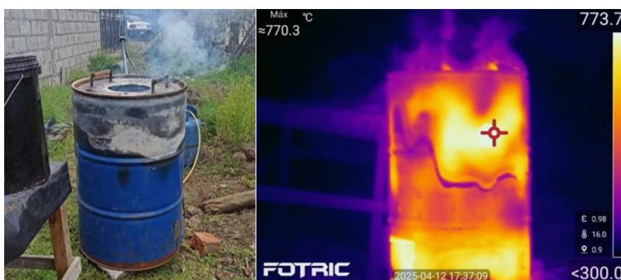
Fig. 3: Horno de quemado de muestras artesanal con mapa de calor a la temperatura de 750°C.
