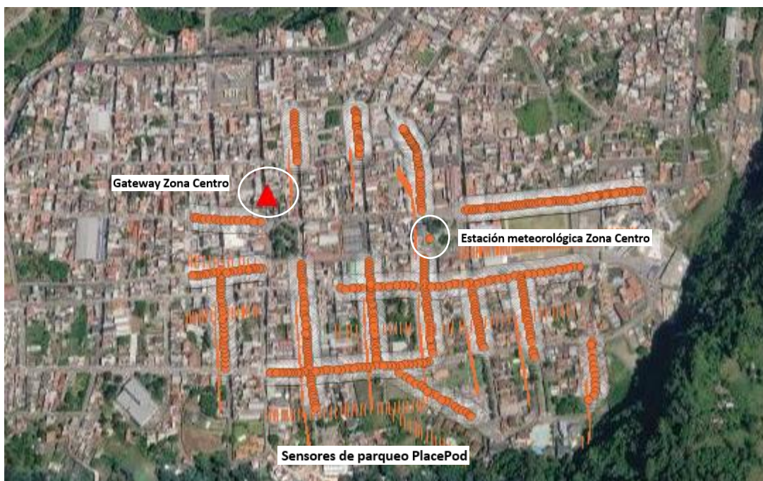
Figura 134. Sistema completo del parqueadero inteligente
