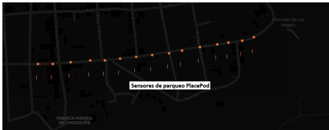
Figura 124. Ubicación de los sensores LoRa
