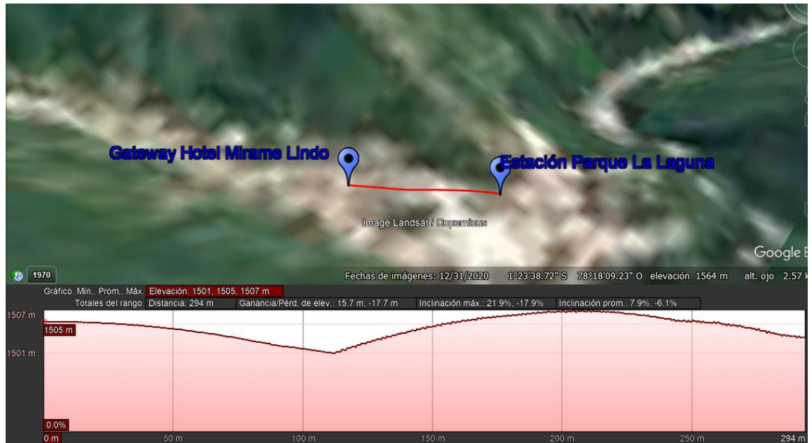
Figura 62. Perfil de elevación correspondiente a la estación meteorológica y la Gateway de la zona de Río Verde
