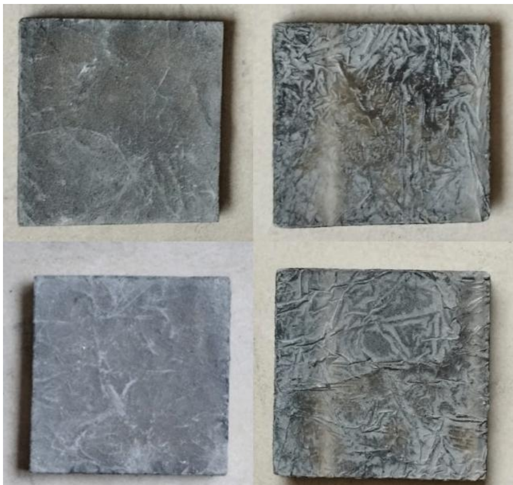
Figura 24. Resultados probetas ensayo de impacto. Fuente. Elaboración Propia.
