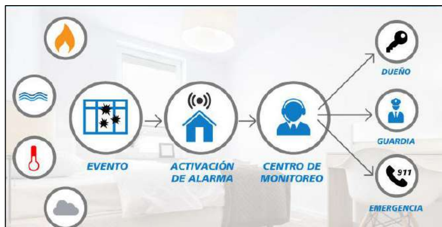
Figura 1. Estructura de un sistema de seguridad electrónica [11]
