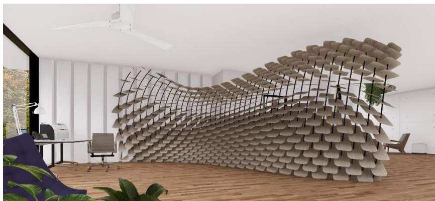
Figura 10. Sistema modular para muros divisorios fabricados con residuos de madera
