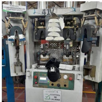
Figura 16. Máquina conformadora de contrafuerte
