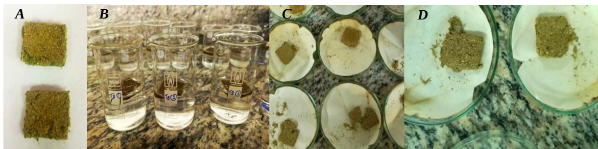
Figura 8. Solubilidad de platos biodegradables germinables a partir de materiales agroindustriales. A: Obtención de muestras; B: Proceso de solubilidad de cada tratamiento; C,D: Secado de las muestras luego del filtrado mediante la metodología descrita por Arancibia et al., (2014) .
