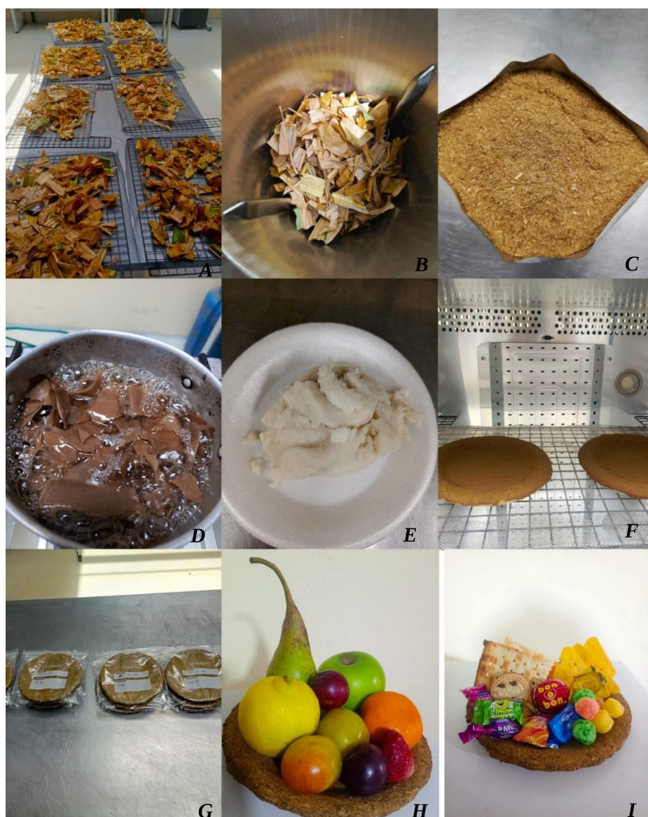
Figura 16. Proceso de elaboración de platos biodegradables germinables. A, B, C: Preparación de materia prima (Maíz); D: Papel Krab; E: Preparación del aglutinante; F: Secado de platos; G: Platos biodegradables germinables terminados y almacenados; H,I: Aplicación del plato biodegradable germinable.
