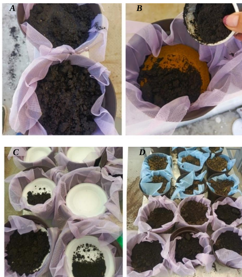
Figura 12. Ensayo de biodegradación de platos biodegradables germinables. A: Muestra de suelo + malla separadora; B, C: Enterrado de plato biodegradable y control (Platos desechables P17 de poliestireno); D: Proceso de biodegradación (45 días).
