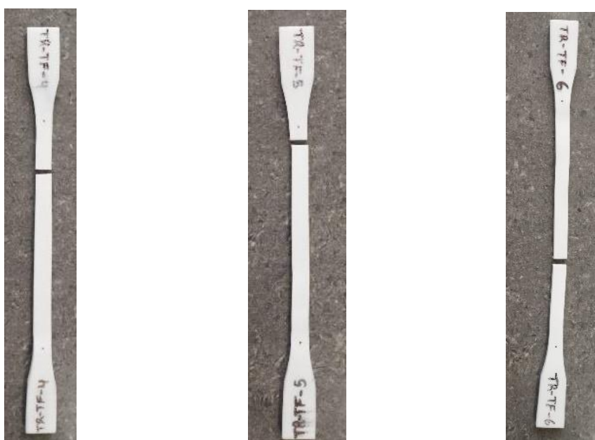
Fig. 69. Probetas de Teflón comercial de la 4 a la 6, después del ensayo de tracción mostrando la zona de cuello y fractura. Fuente: Elaboración propia.
