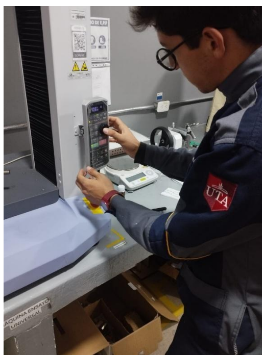
Fig. 56. Control de los parámetros de velocidad en la máquina Shimadzu AGS-X.
