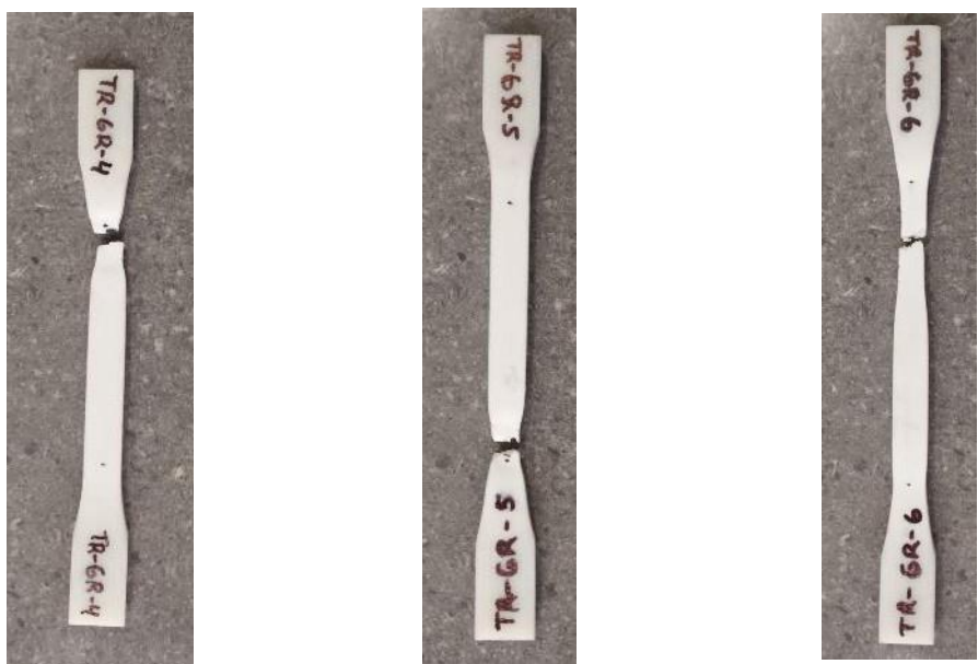
Fig. 66. Probetas de Grilon comercial de la 4 a la 6, después del ensayo de tracción mostrando la zona de cuello y fractura. Fuente: Elaboración propia.
