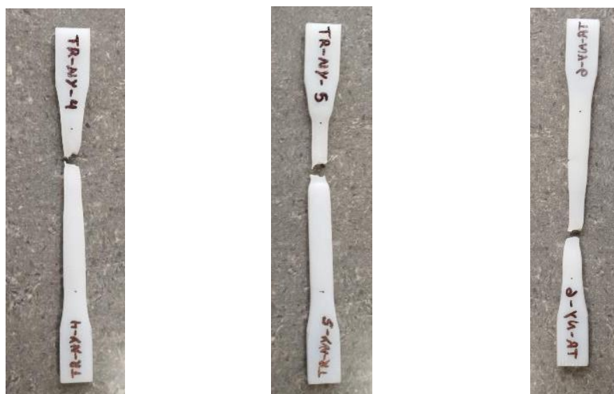
Fig. 72. Probetas de Nylon comercial de la 4 a la 6, después del ensayo de tracción mostrando la zona de cuello y fractura. Fuente: Elaboración propia.
