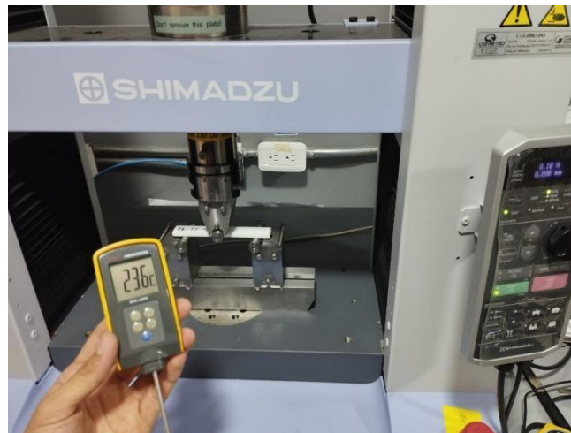
Fig. 54. Control de temperatura durante el ensayo en el laboratorio. Fuente: Elaboración propia.
