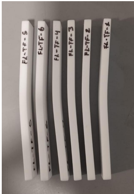
Fig. 84. Probetas del Teflón comercial durante el ensayo de flexión en tres puntos mostrando la alta flexibilidad característica de este material.
