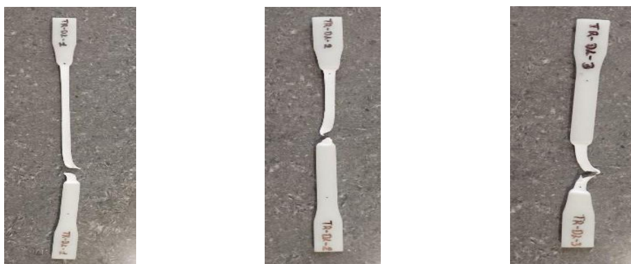
Fig. 62. Probetas de Duralón comercial de la 1 a la 3, después del ensayo de tracción mostrando la zona de cuello y fractura.
