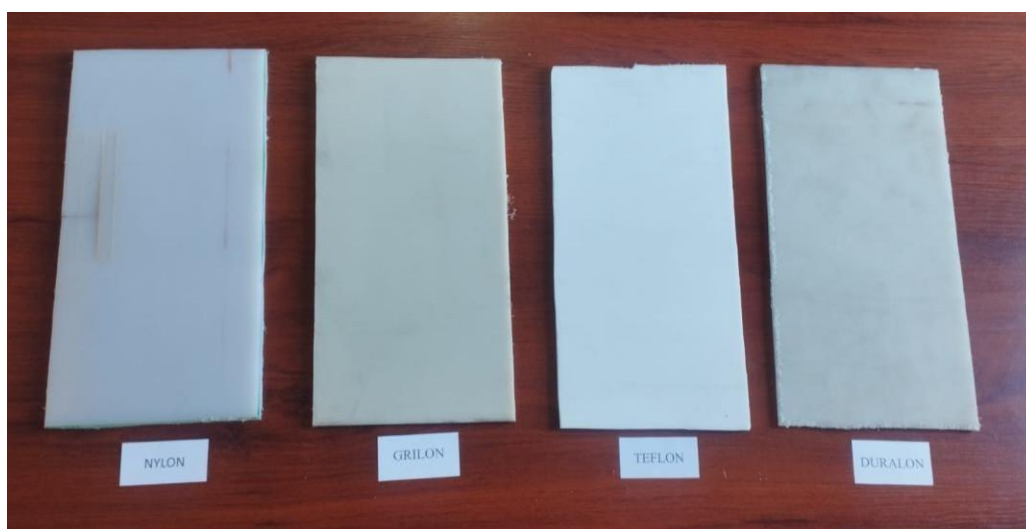
Fig. 44. Planchas de los polímeros comerciales adquiridos: (a) Nylon, (b) Grilon, (c) Teflón, (d) Duralón. Fuente: Elaboración propia.
