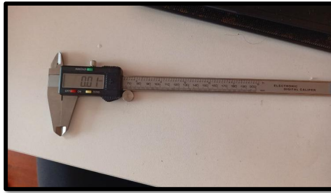
Fig. 36. Calibrador pie de rey digital Tronic Digital Caliper con resolución de 0,01 mm utilizado para la medición dimensional de las probetas. Fuente: Elaboración propia.
