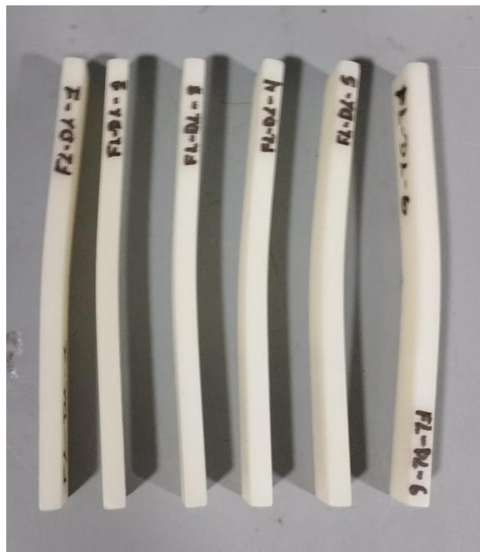
Fig. 80. Probetas del Duralón comercial durante el ensayo de flexión en tres puntos mostrando la deflexión característica sin fractura.
