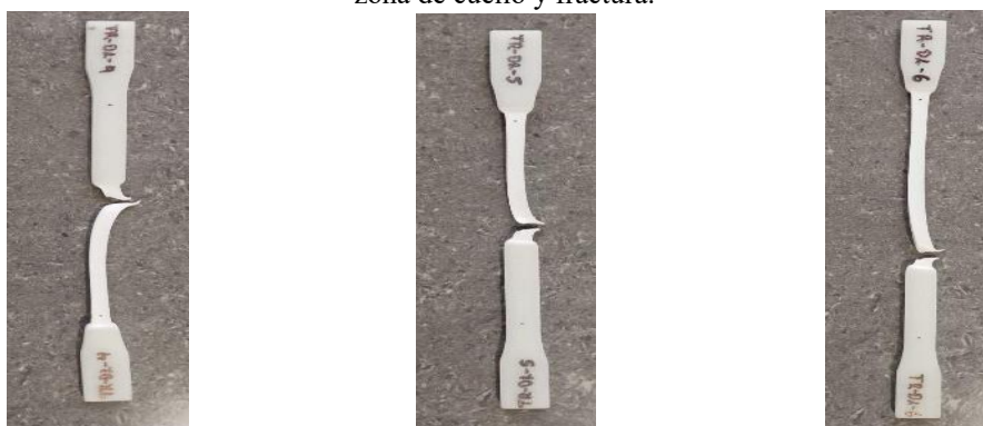
Fig. 63. Probetas de Duralón comercial de la 4 a la 6, después del ensayo de tracción mostrando la zona de cuello y fractura.
