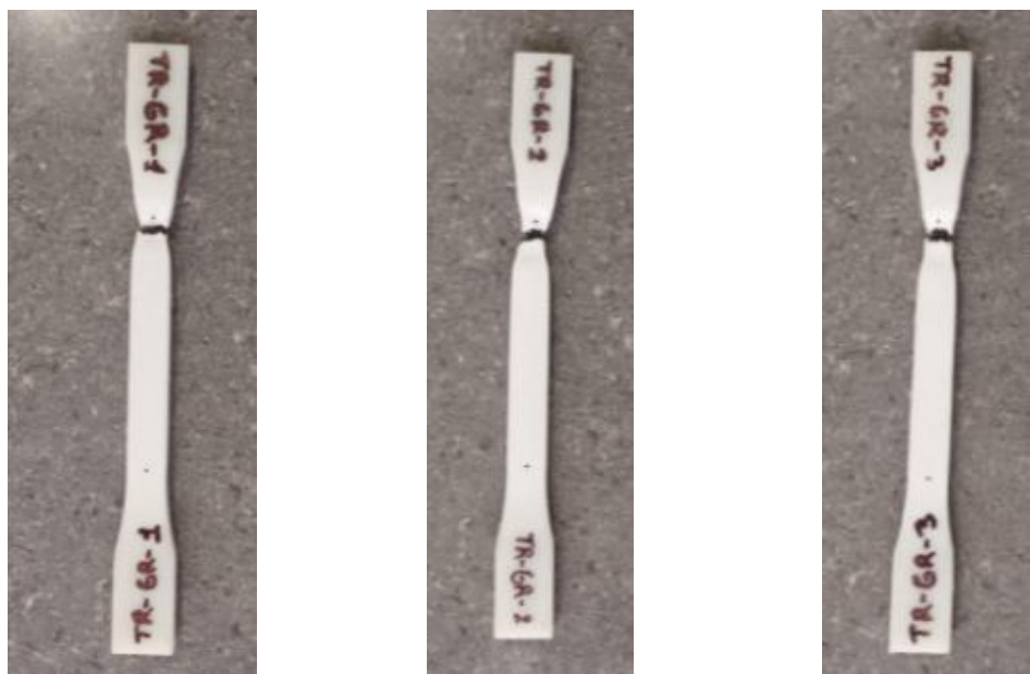
Fig. 65. Probetas de Grilon comercial de la 1 a la 3, después del ensayo de tracción mostrando la zona de cuello y fractura. Fuente: Elaboración propia.
