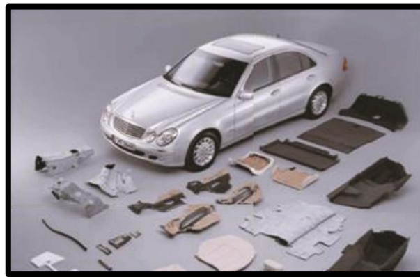
Fig. 9. Un vehículo que muestra numerosas piezas producidas por PMC. [24]
