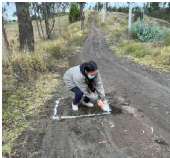
Fig. 4. Delimitación de calicatas
