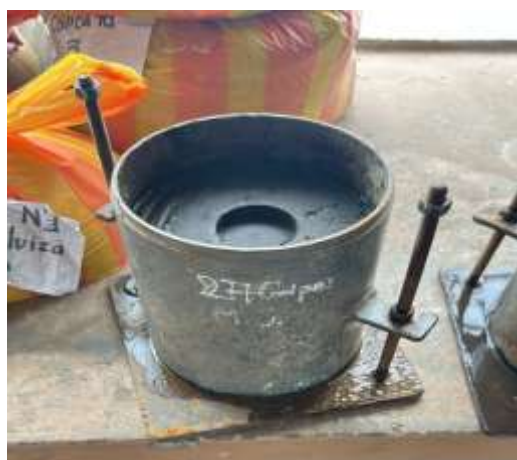
Fig. 11. Muestra de CBR luego del ensayo
