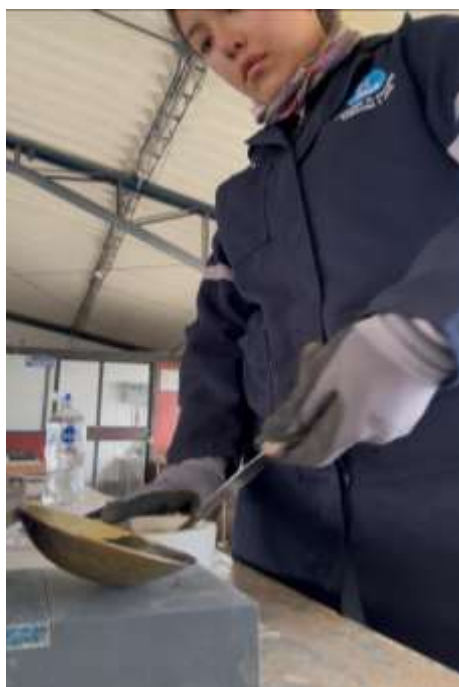
Fig. 7. Ensayo límite líquido con la copa de Casagrande
