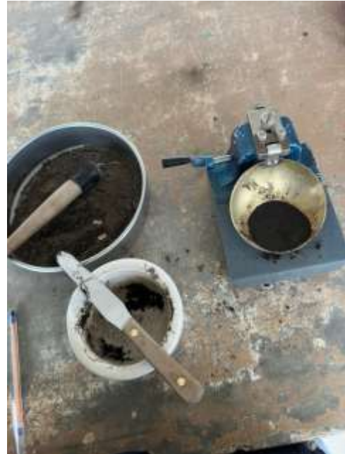
6. Equipo para determinar límites de Atterberg
