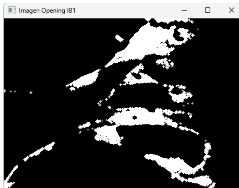
Figura 54. Filtrado morfológico de apertura
