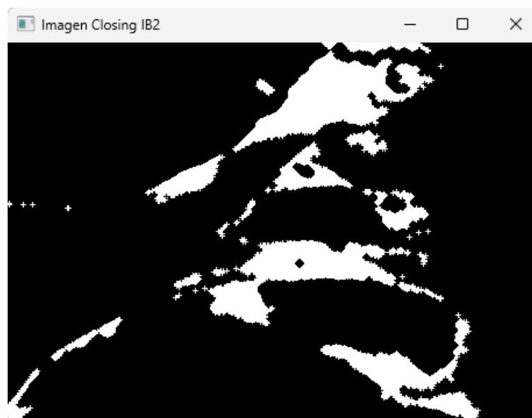
Figura 55. Filtrado morfológico de cerradura
