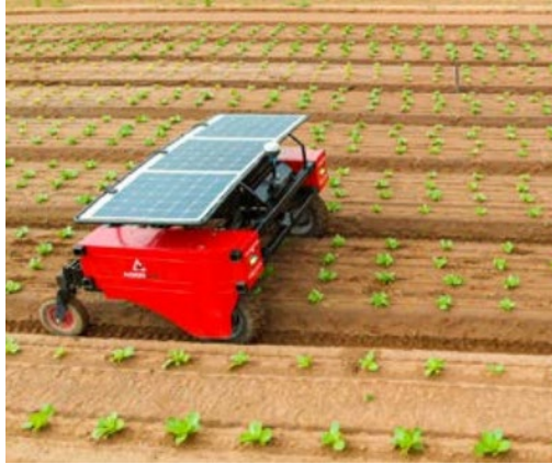
Figura 7. Ejemplo de robot agrícola Agerris para control de maleza alimentado por energía solar[9].
