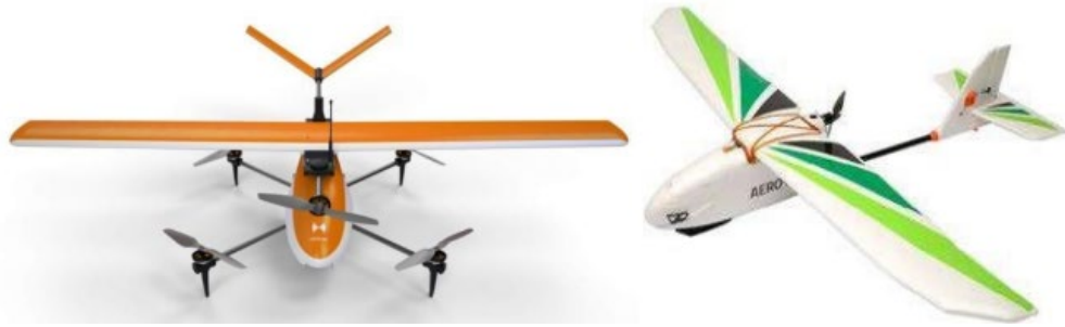
Figura 10. Modelos de dron de ala fija[20].
