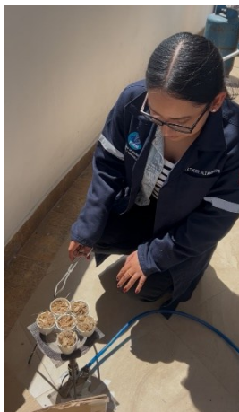
Fig. 8. Calcinación previa de la planta de totora.
