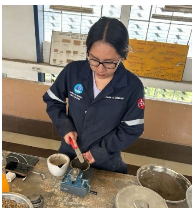
Fig. 19. Ensayo límite líquido en laboratorio.
