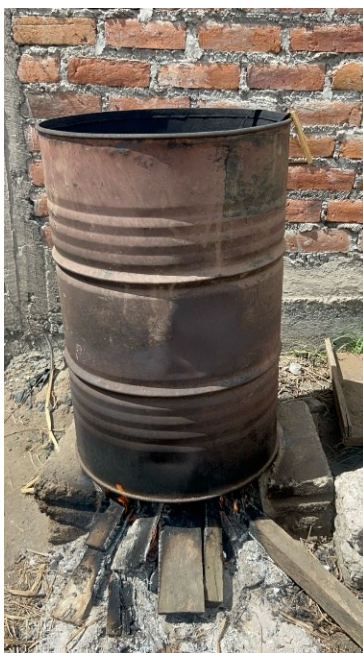
Fig. 10. Horno artesanal para calcinación.
