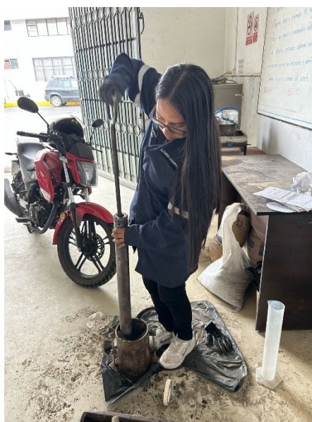
Fig. 25. Ensayo CBR en laboratorio.
