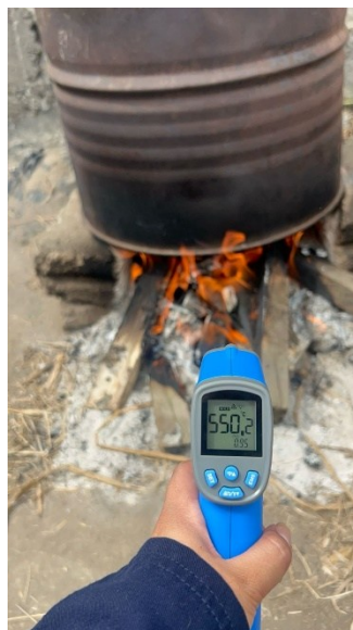
Fig. 11. Control de la temperatura de calcinación de la totora.
