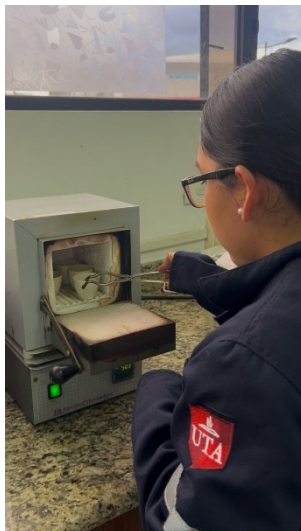
Fig. 7. Calentamiento de los crisoles para el ensayo de determinación de temperatura de calcinación.
