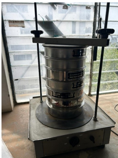
Fig. 16. Ensayo de granulometría.
