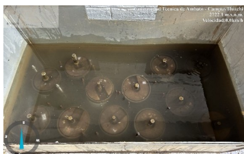
Fig. 27. Muestras de CBR en inmersión.
