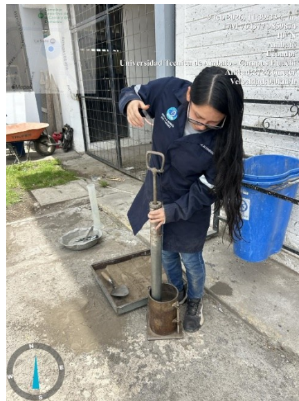
Fig. 24. Ensayo Proctor modificado en el laboratorio.
