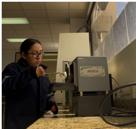
Fig. 9. Calcinación de la totora en laboratorio.
