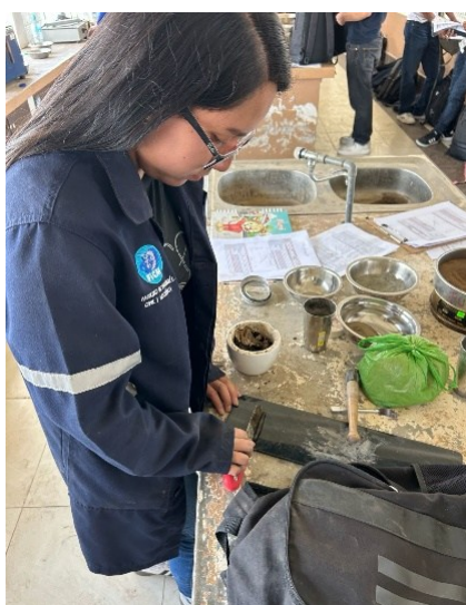
Fig. 21. Ensayo límite plástico en laboratorio.
